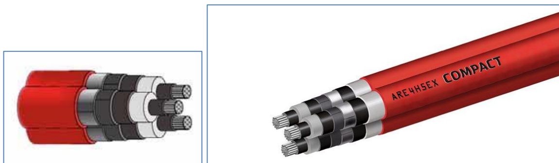
Figura 10. Esempio commerciale di cavi elettrici MT tripolari a elica visibile
