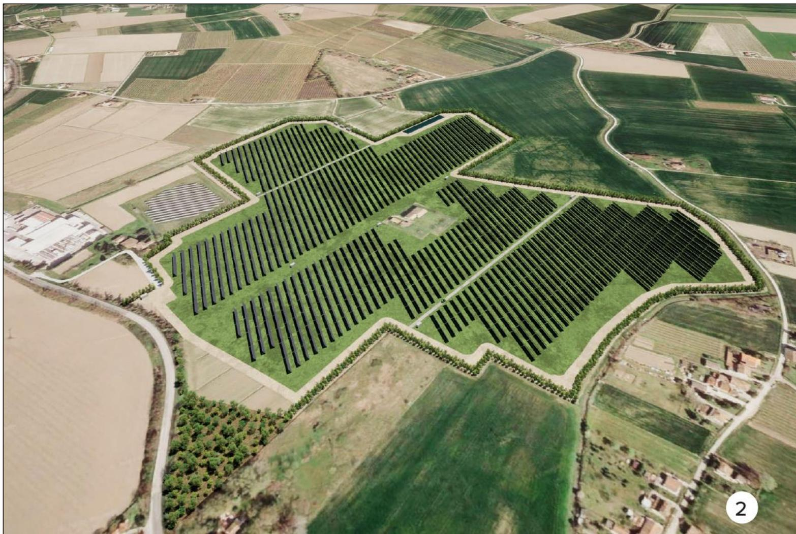
**Figura 88.** Vista 3D degli interventi in progetto, con rappresentazione grafica della componente ambientale del progetto (fasce arboreo-arbustive perimetrali e area boschiva) e della componente tecnologica (pannelli fotovoltaici, strade, locali tecnici).
