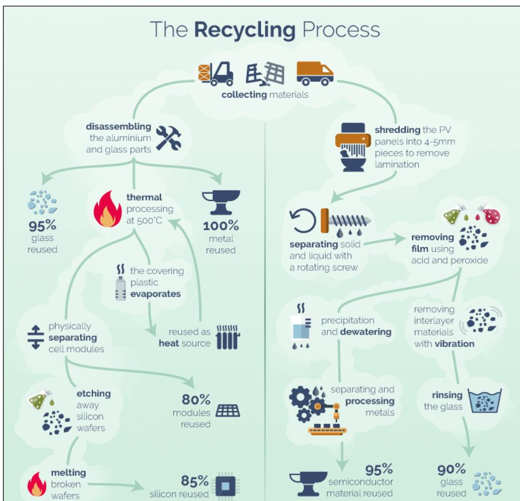
**Figura 69.** Il processo di riciclo dei moduli fotovoltaici a base silicea e dei sottoprodotti della dismissione di impianti fotovoltaici. Fonte: [www.greenmatch.co.uk/blog/2017/10/the-opportunities-of-solar-panel-recycling](http://www.greenmatch.co.uk/blog/2017/10/the-opportunities-of-solar-panel-recycling) (Ultimo accesso: febbraio 2020).
