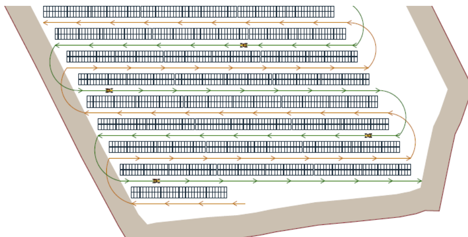
Figura 21. Particolare planimetrico delle lavorazioni su file alternate e fascia di manovra perimetrale.
