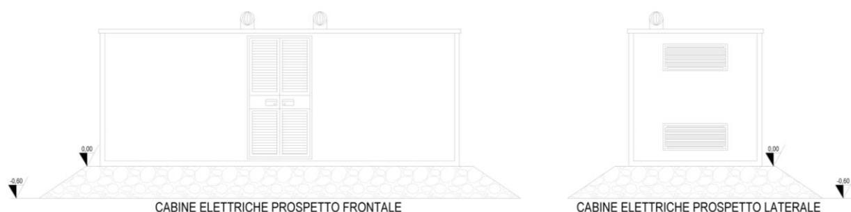
Figura 3.1: Posa Sopraelevata delle Cabine di Consegna
