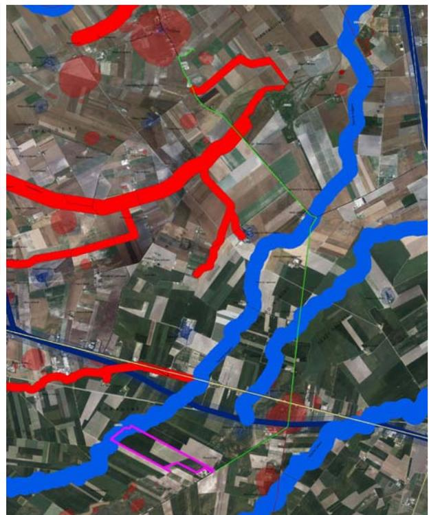
In riferimento al percorso di collegamento alla sottostazione 30/36kV in località "Palmori", il cavidotto sarà interrato alla profondità superiore al metro.
