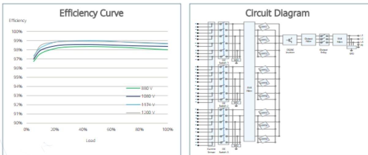
**Fig. 9 - Dimensioni, specifiche tecniche e prestazionali dell'inverter**
