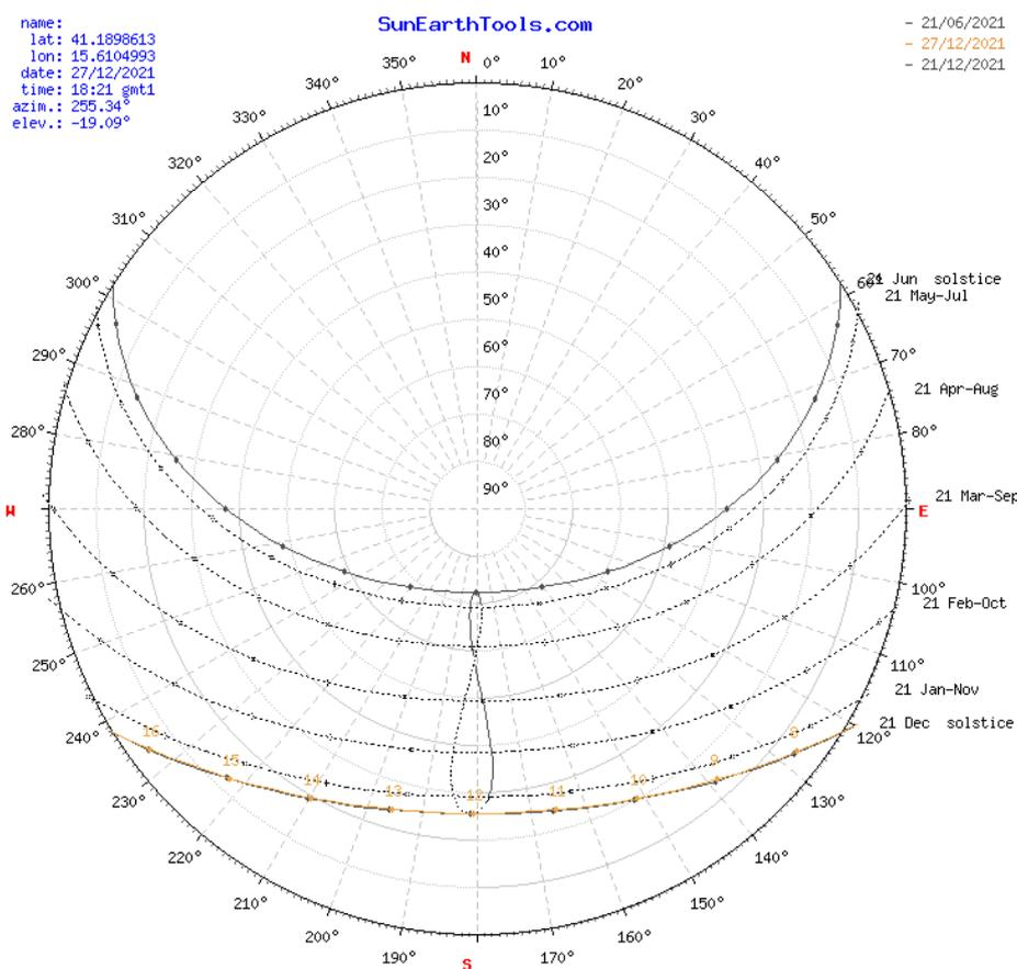
**Fig. 19 - Diagramma Solare Polare**
