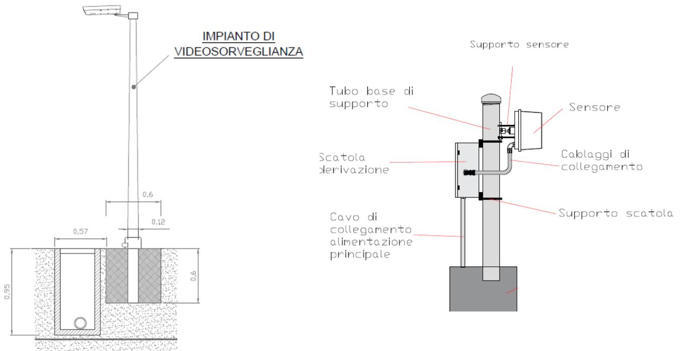
**Fig. 16 – Sistema antintrusione**
