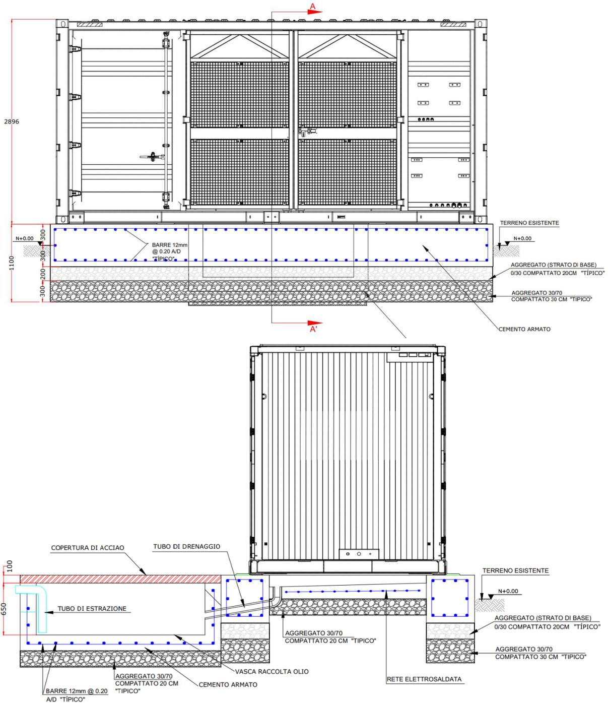
**Fig. 14 - Cabina di trasformazione BT/MT**
