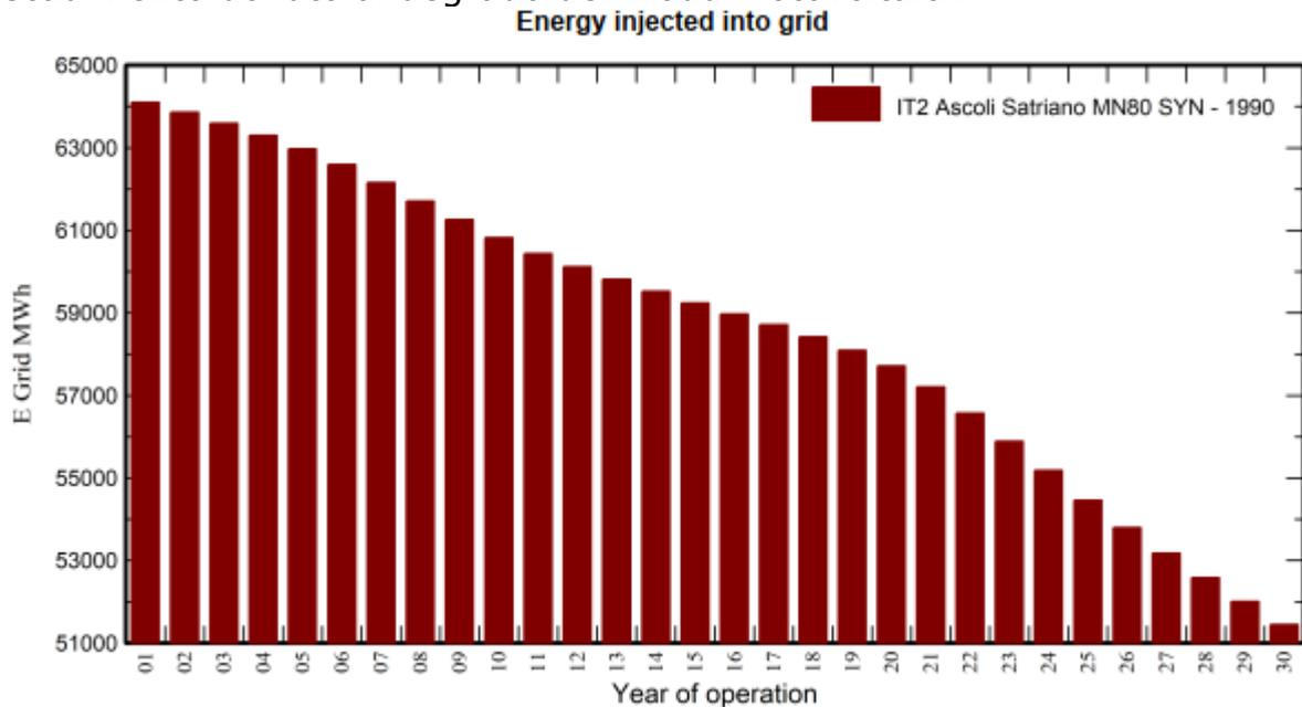
**Fig. 22 – Producibilità dell'impianto con degrado moduli (30 anni)**
