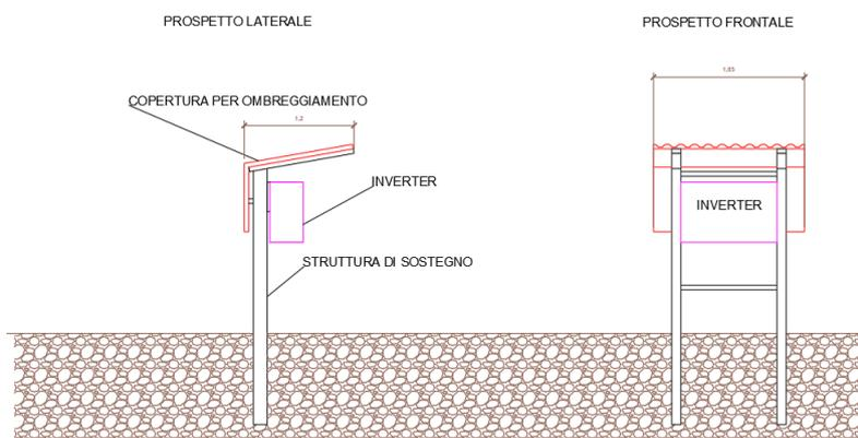
**Fig. 6 - Tipico struttura supporto inverter**
