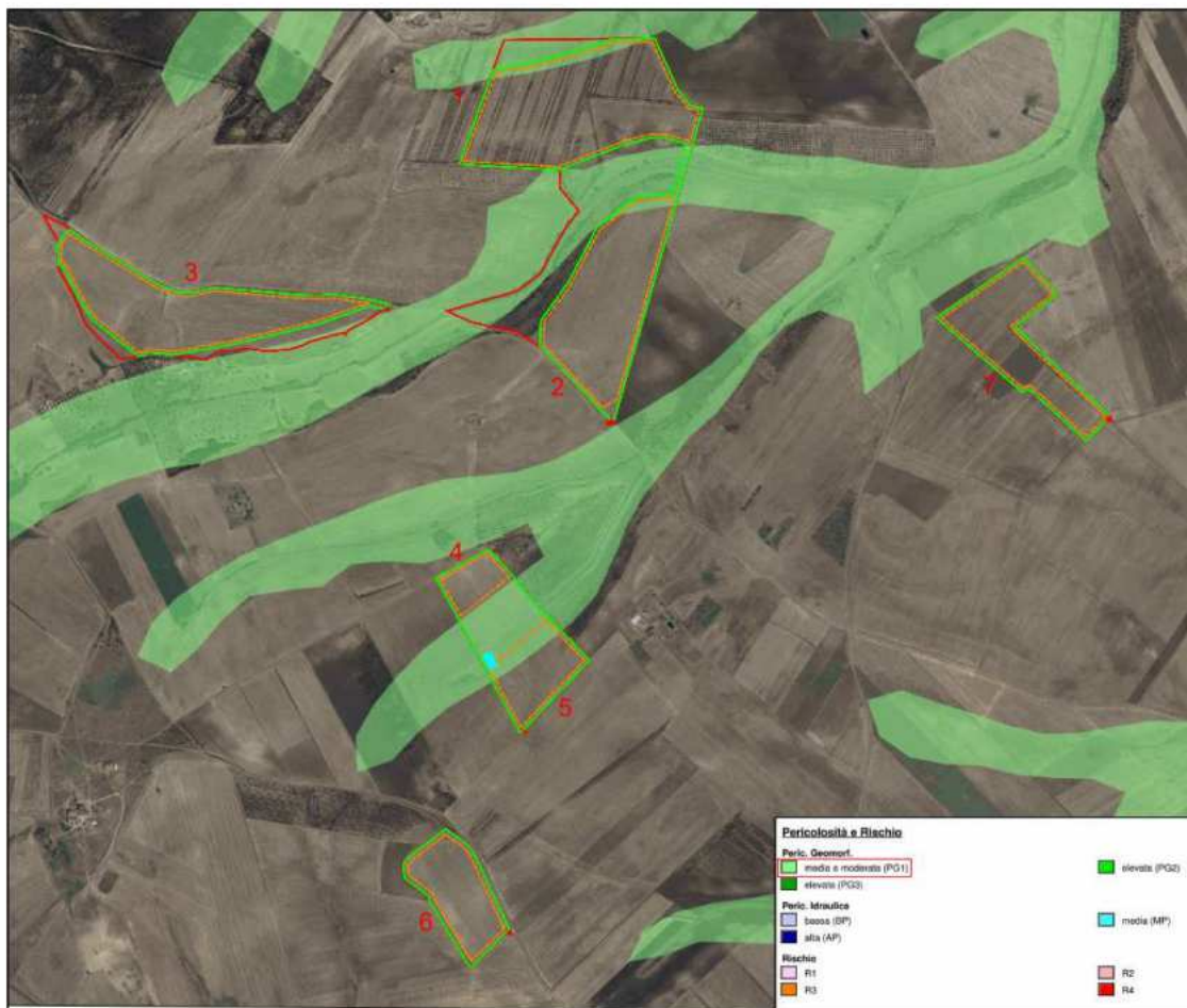
Figura 6 Area del parco fotovoltaico sovrapposizione vincoli PAI
