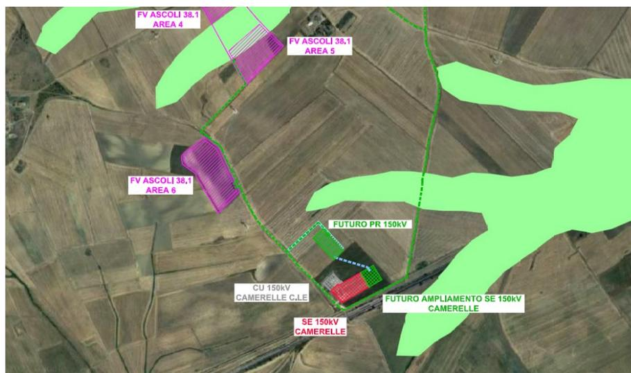
Le criticità emerse dall'esame idrografico e geomorfologico sono state tenute in apposita considerazione escludendo le aree perimetrare PG1 e i corsi d'acqua dall'installazione dell'impianto.
