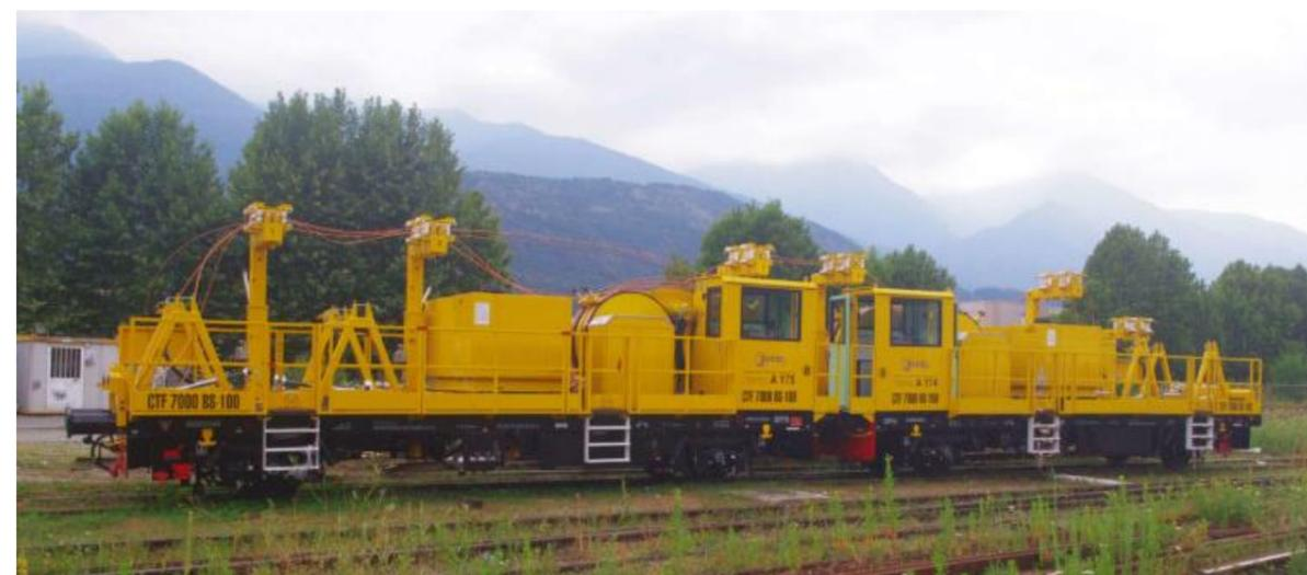
Figura 2-14 Esempio di carro di tesatura
