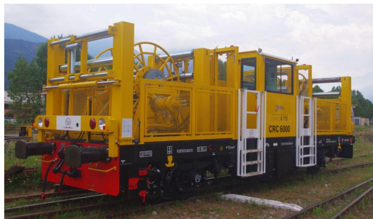
Figura 2-13 Esempio di carro porta bobine
