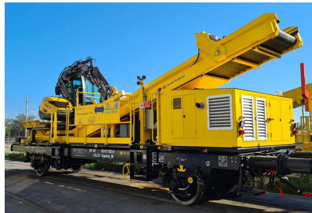
*Figura 2-10 Esempio di escavatore con nastro di carico*
