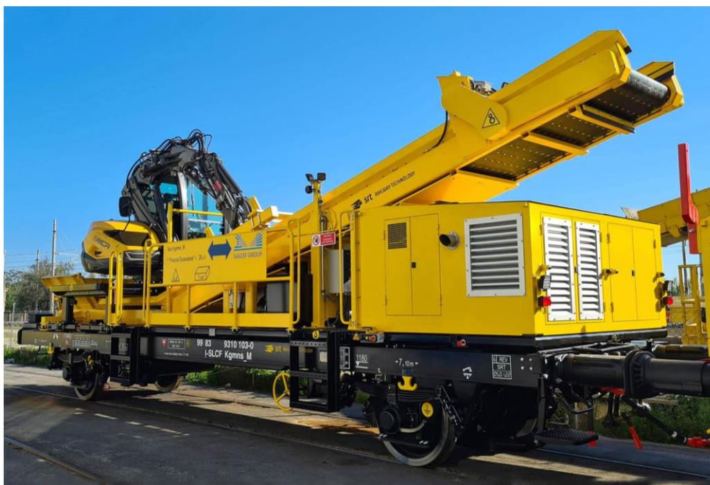
Figura 3-6 Esempio di escavatore con nastro di carico
