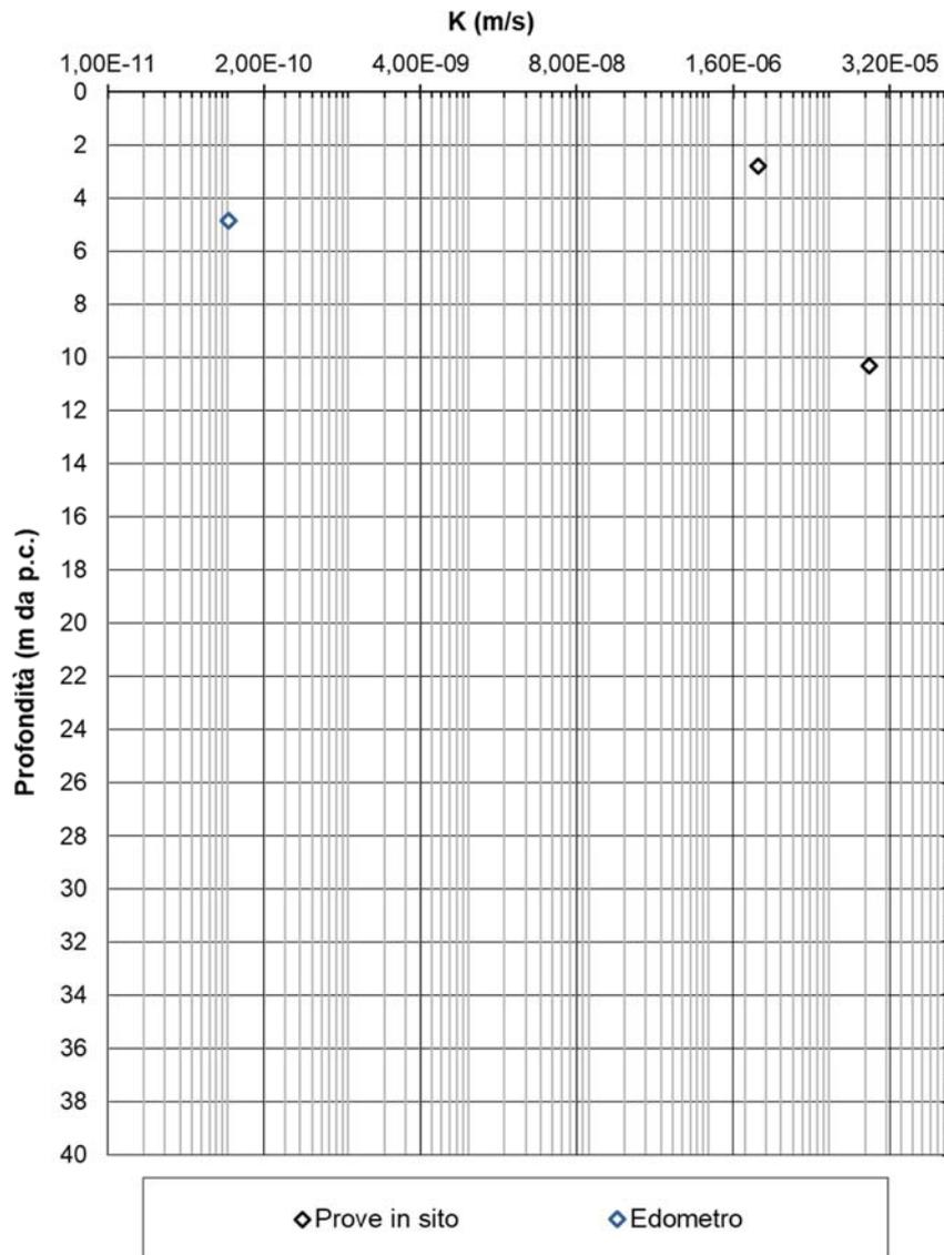
Figura 8-18 – Coefficienti di permeabilità
