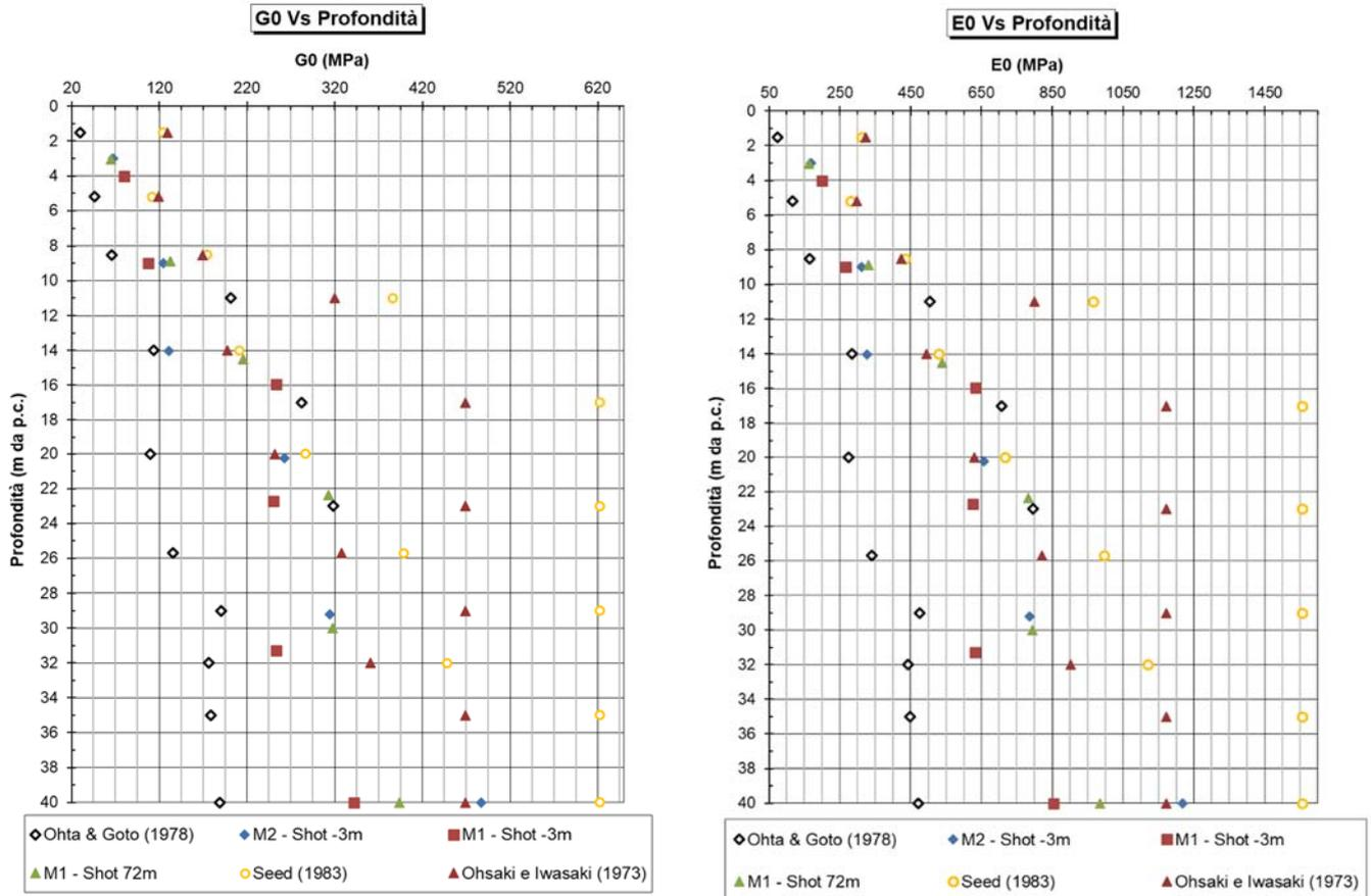
Figura 8-4 – Modulo di taglio a piccole deformazioni  $G_0$  (a sinistra) Modulo elastico a piccole deformazioni  $E_0$  (a destra)
