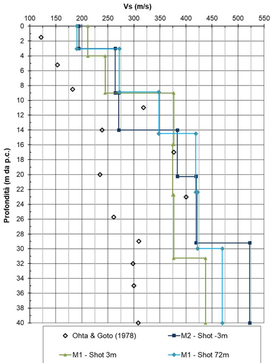
Figura 8-3 – Velocità delle onde di taglio  $V_s$
