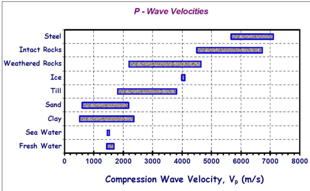
Figura 8-7 – Valori della velocità delle onde di corpo  $V_p$  per differenti materiali
