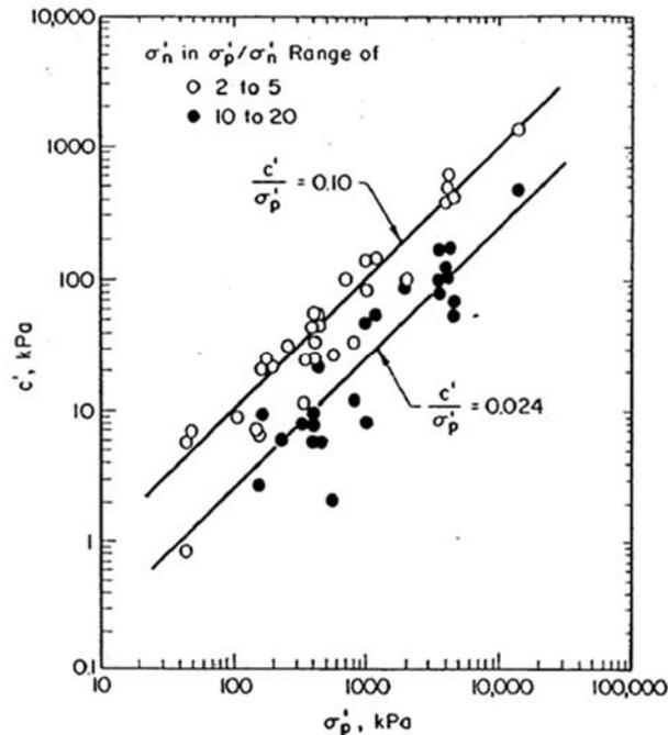
Figura 7-4 - Relazione fra la coesione efficace intercetta  $c'$ , la pressione di preconsolidazione  $\sigma_p'$ , e la tensione efficace normale agente sulla superficie di rottura  $\sigma_n$  (Mesri e Abdel – Ghaffar, 1993 [39]).
