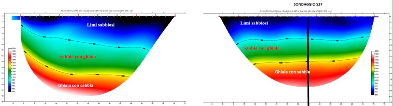
Figura 8-6 – Estratto dei risultati delle prove sismiche a rifrazione
