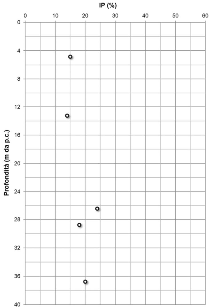
Figura 8-13 – Caratteristiche di plasticità: Indice di plasticità
