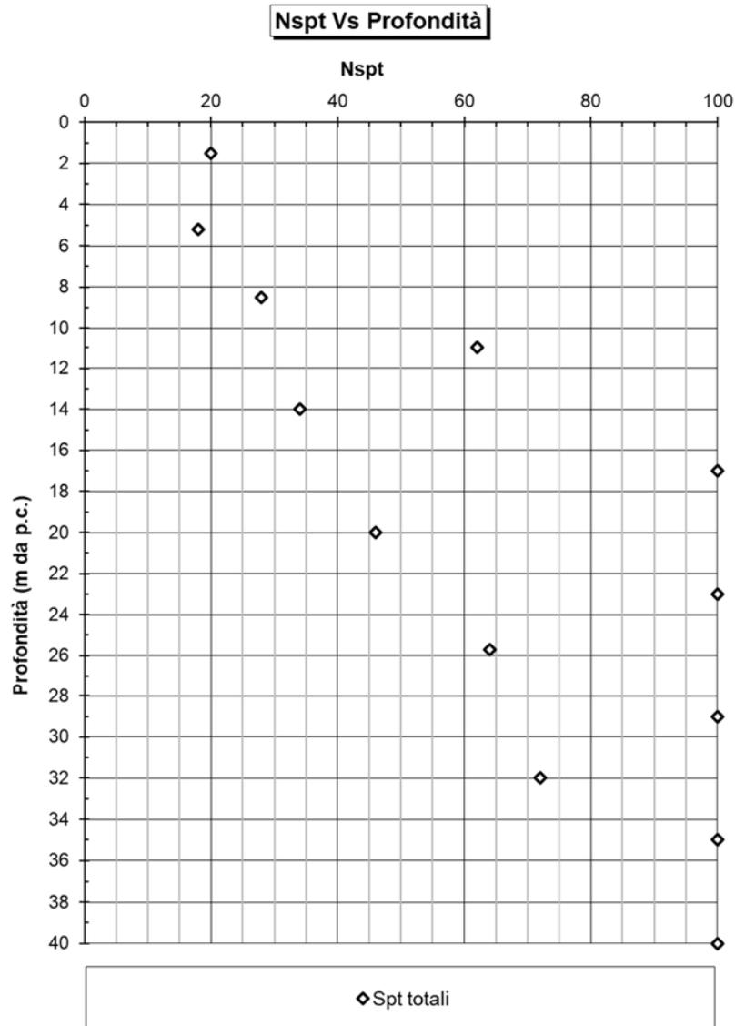
Figura 5-2 – Risultati delle prove penetrometriche dinamiche (SPT)  $N_{spt}$
