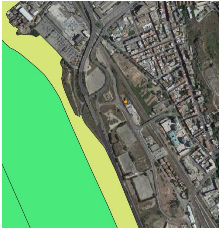
Figura 4-3 Fasce PSFF – in giallo: Hi1; in viola: Hi2; in blu: Hi3; in verde: Hi4. Sito di intervento: pallino giallo
