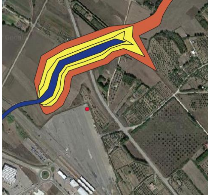
Figura 4-1 Fasce PAI – in arancione: P1; in giallo: P2; in blu: P3. Sito di intervento: pallino rosso
