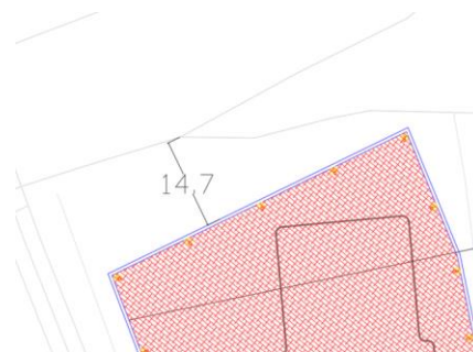
Figura 4-4 Stralcio Planimetrico – distanza minima incisione-piazzale di progetto
