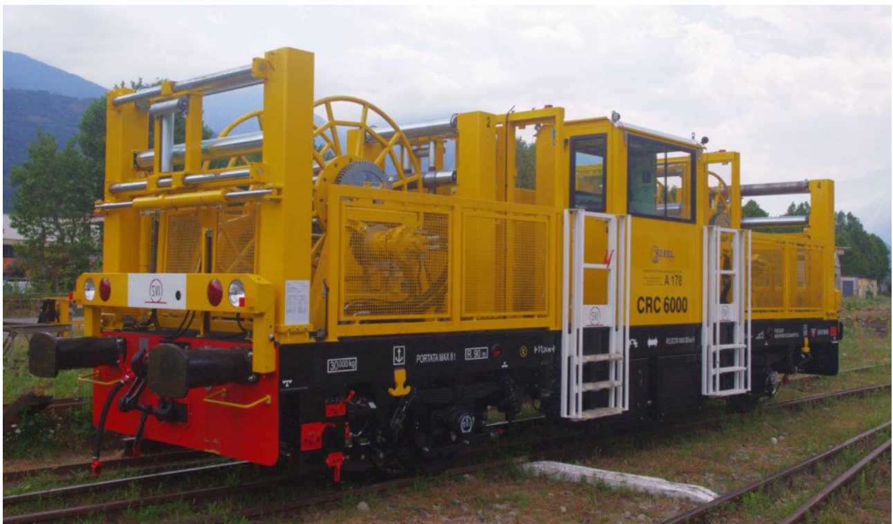
Figura 2-8 Esempio di carro porta bobine
