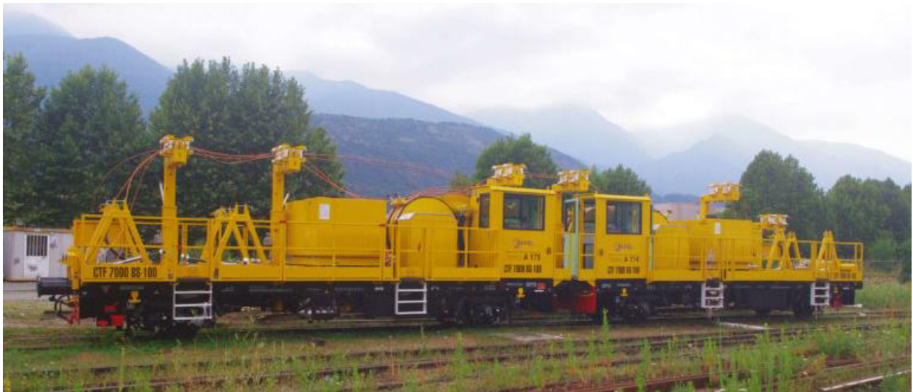
Figura 2-9 Esempio di carro di tesatura
