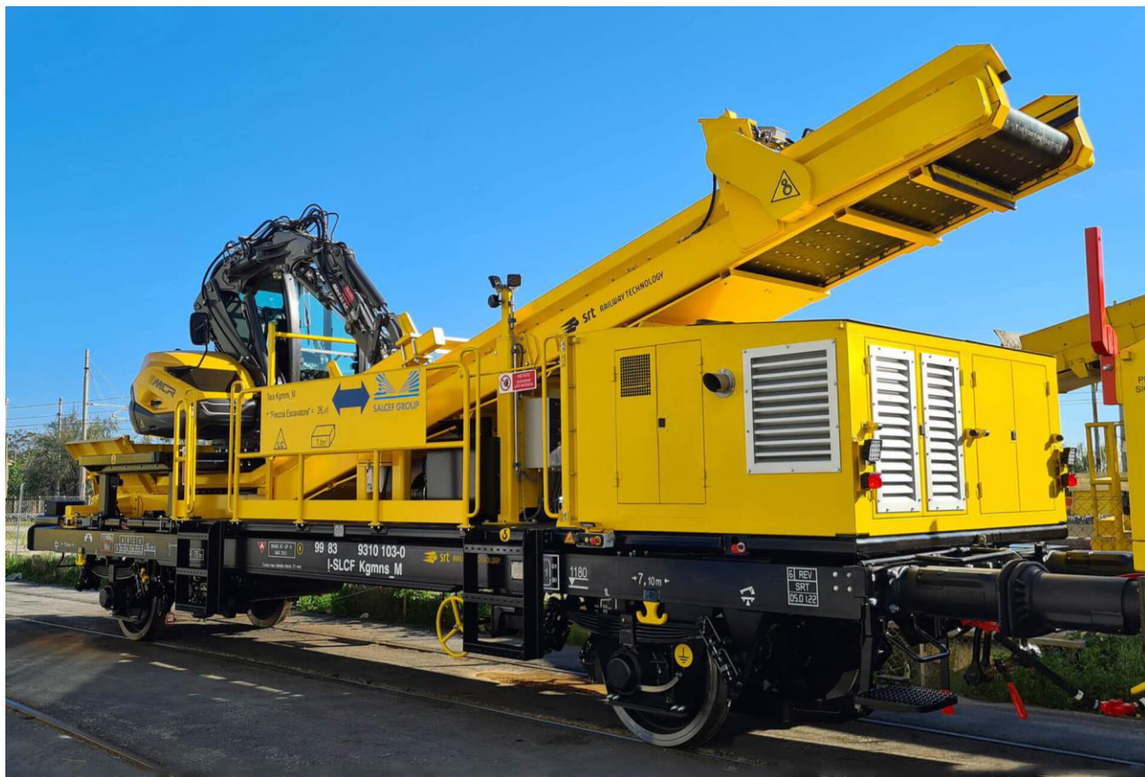
Figura 2-5 Esempio di escavatore con nastro di carico
