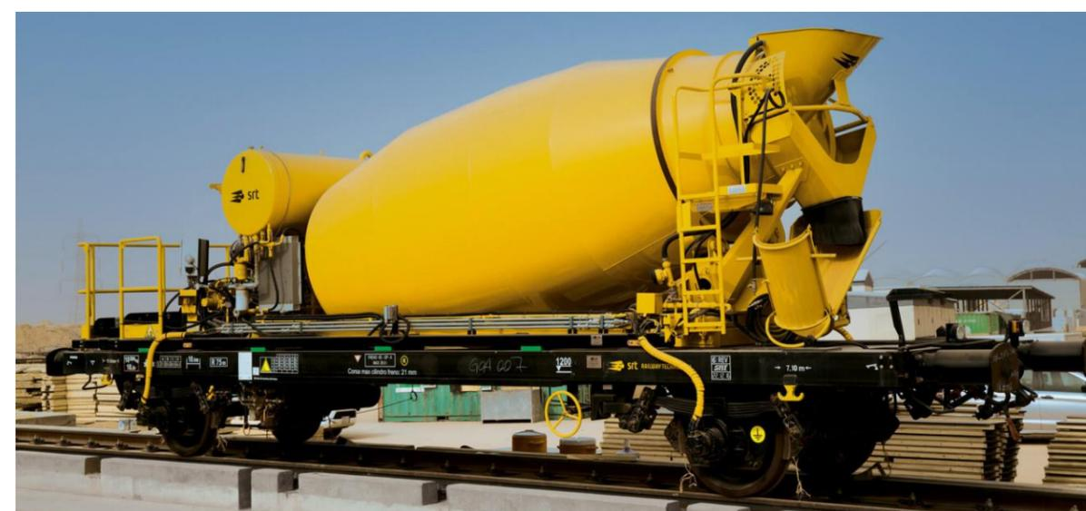
*Figura 2-11 Esempio di betoniera per il trasporto ed il getto di calcestruzzo in opera*
