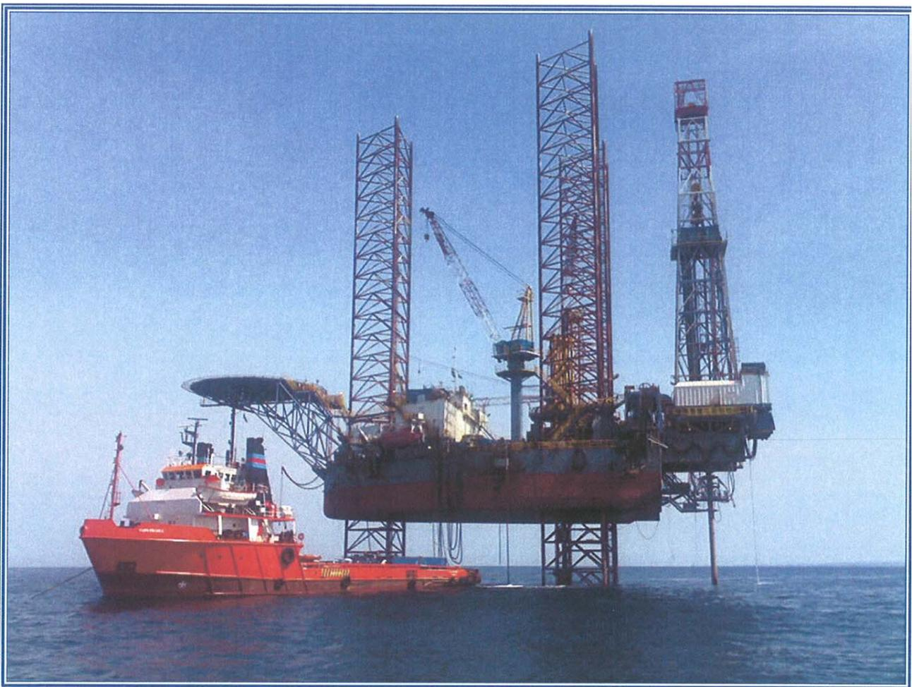
Figura 2.5.a – Foto dell'impianto di perforazione Jack-up "G.H. GALLOWAY" con nave appoggio
