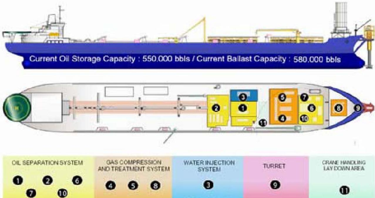
Figura 2.6.4.d – Allestimento tipico di un FPSO della tipologia che verrà impiegata nel progetto. Fonte: SAIPEM
