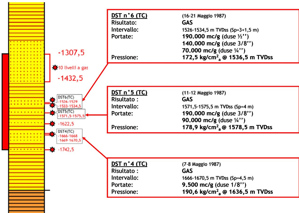
Figura 2.1.3.2.b – Risultati minerali del pozzo OBM1 - Dettaglio della sequenza pliocenica
