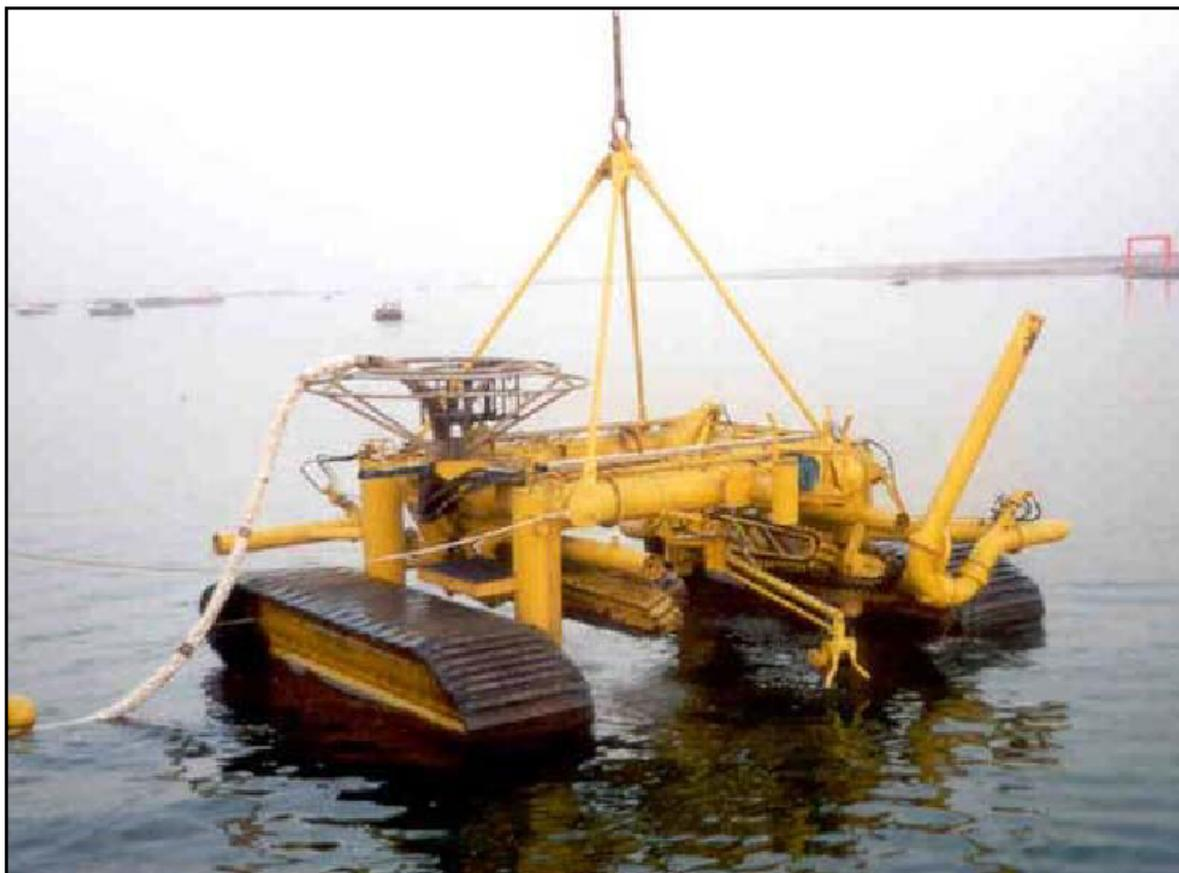
Figura 2.7.3.2.c –Foto di una macchina di scavo con sistemi di taglio meccanico
