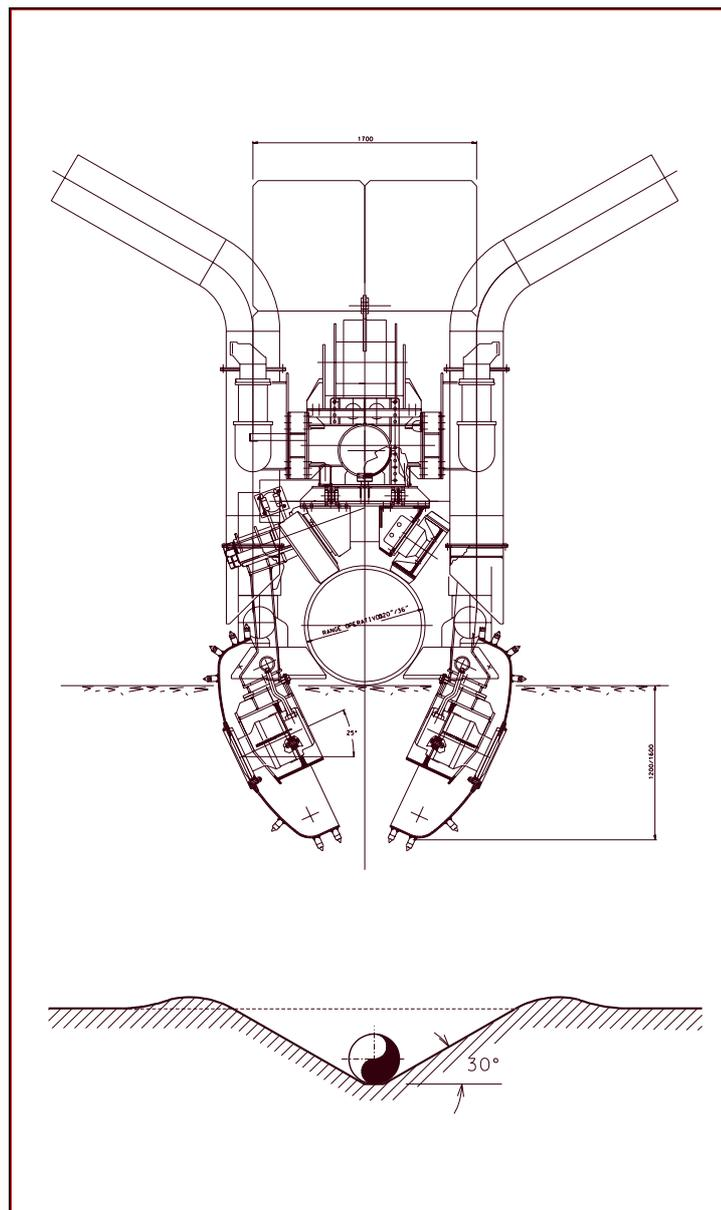
Figura 2.7.3.2.a - Esempio di mezzo per interro e sezione tipica.
