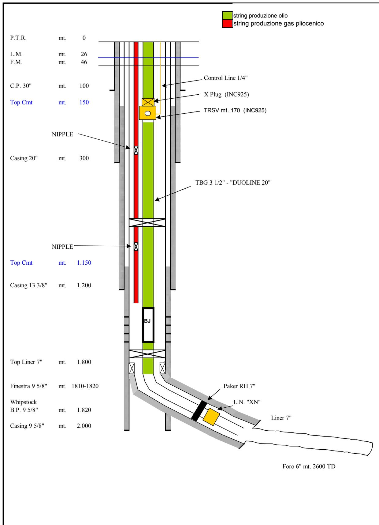
Figura 2.5.3.a – Esempio di schema di perforazione e completamento dei pozzi produttivi a olio e gas pliocenico
