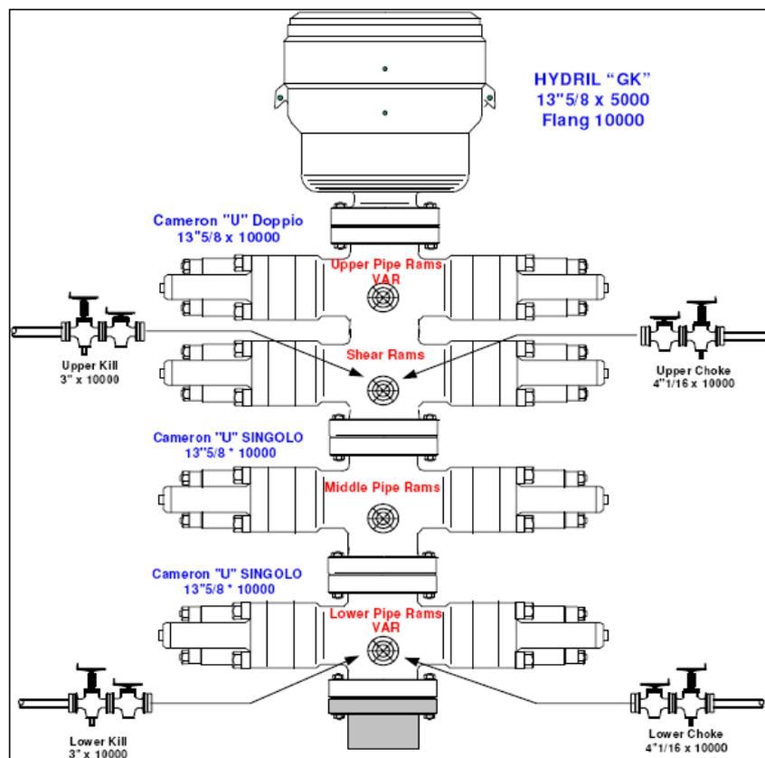
Figura 2.5.5.1.c – Schema del B.O.P da 13”5/8-10000
