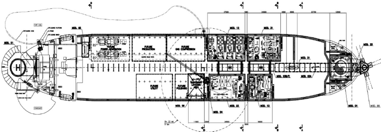
Figura 2.6.4.c – Esempio di FPSO attrezzata con impianti tipo di processo, torretta esterna per ormeggio, gru, eliporto, ecc. Fonte SAIPEM.
