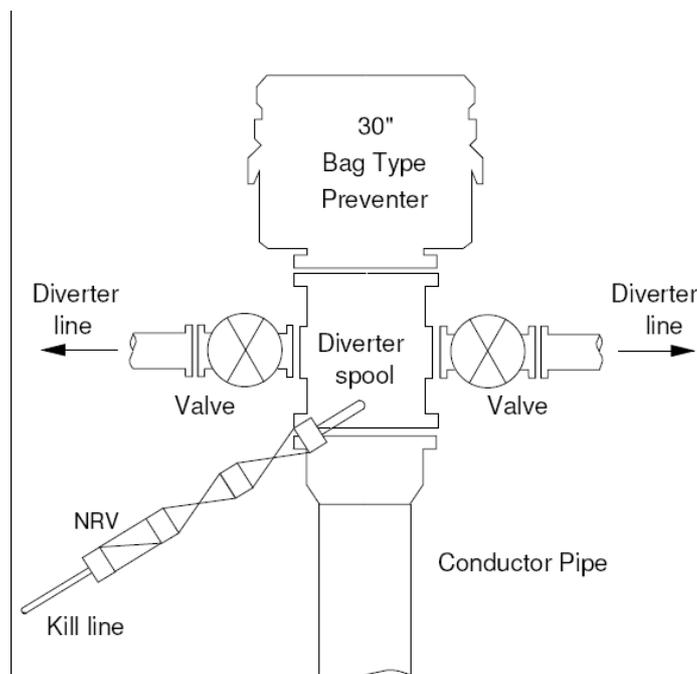
Figura 2.5.5.1.a – Schema di Diverter di superficie installato sul conductor pipe
