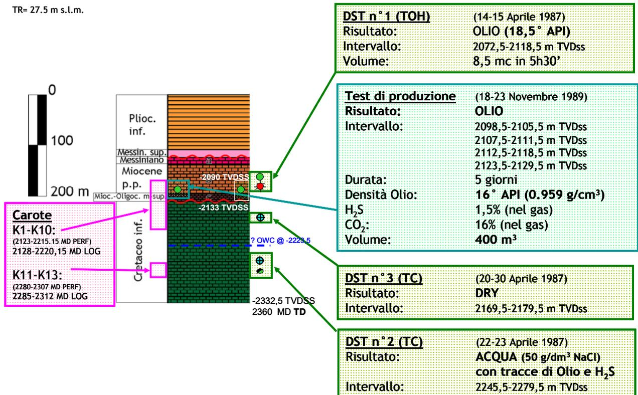
Figura 2.1.3.2.c – Risultati minerali del pozzo OBM1 - Dettaglio della sequenza carbonatica
