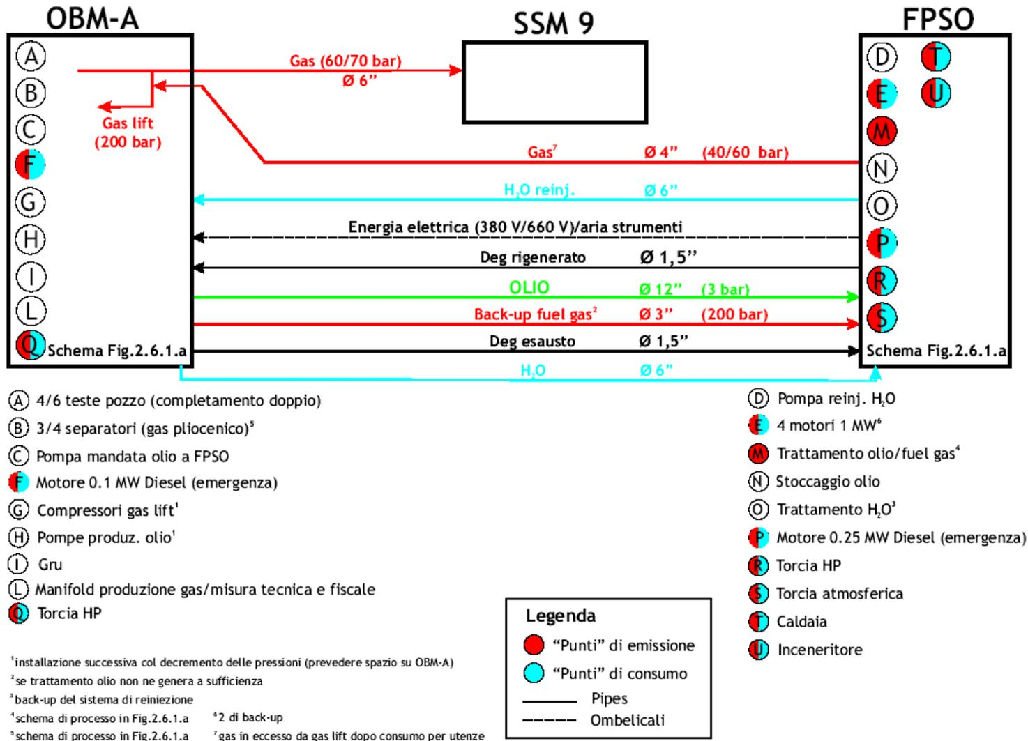
Figura 2.6.6.a – Flussi di materia ed energia scambiate dagli impianti in progetto
