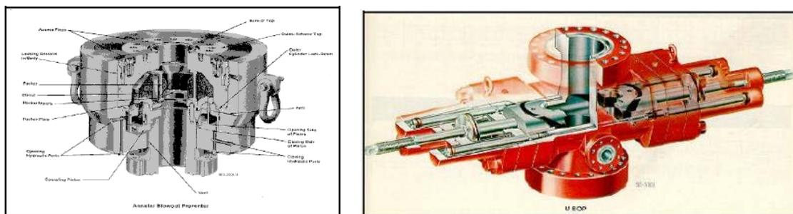
Figura 2.5.2.c - Impianto di perforazione – BOP anulare (a sinistra) e a ganasce (a destra)
