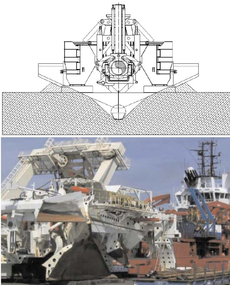
Figura 2.7.3.2.d – Schema di scavo e foto di una macchina ad aratro
