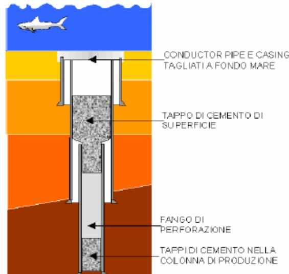
Figura 2.8.a – Esempio di profilo di chiusura mineraria
