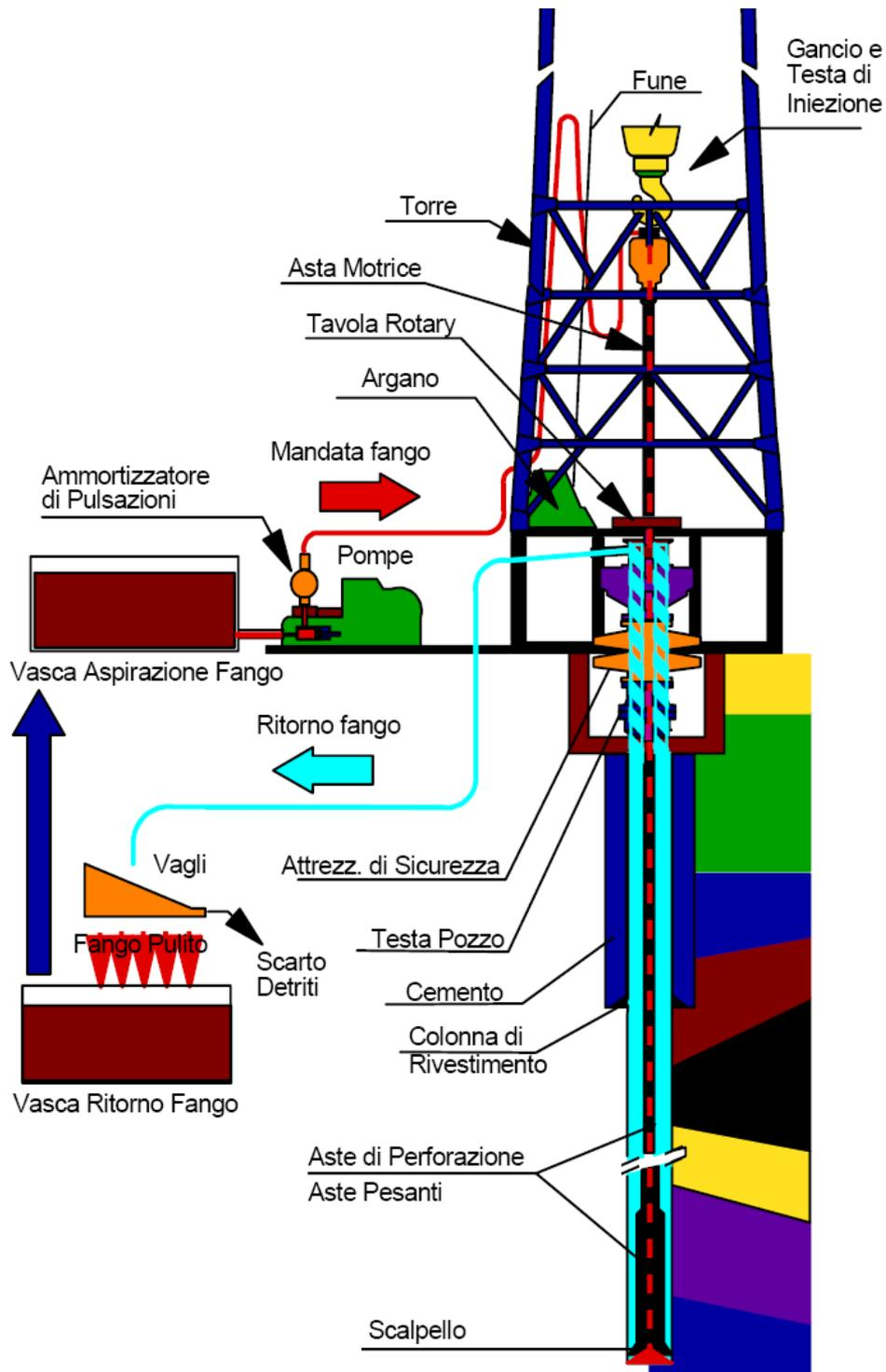
Figura 2.5.2.a - Elementi principali dell'impianto di perforazione (tipico)
