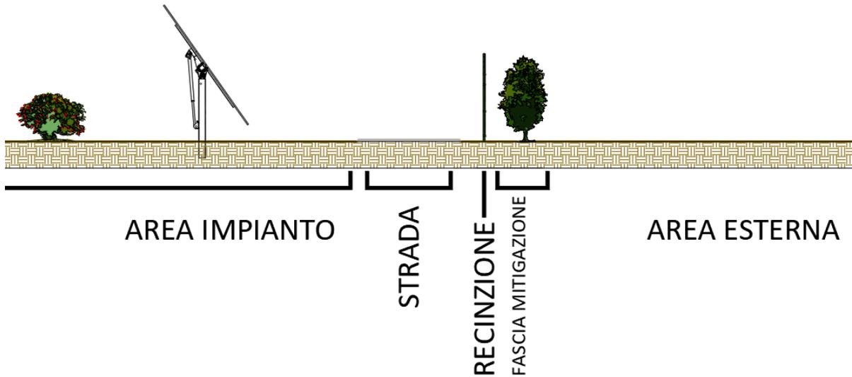
Figura 8 – Fascia di mitigazione perimetrale in sezione
