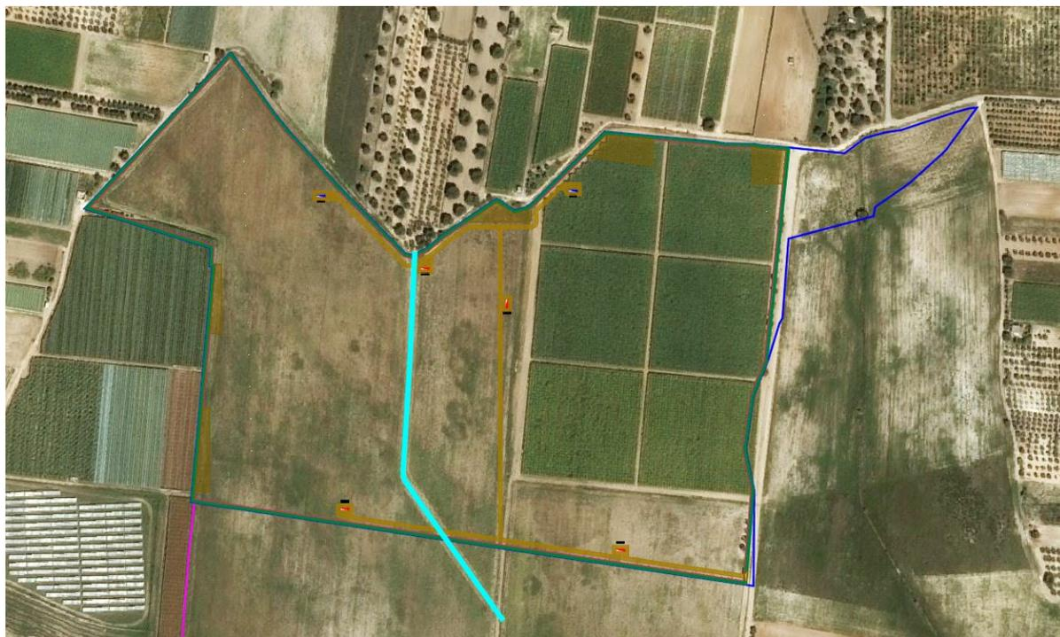
Come è possibile rilevare nelle figura precedente, l'impiuvio e, quindi, il canale in progetto interferisce con la viabilità interna del parco fotovoltaico e, pertanto, sarà necessario prevedere dei tombini idraulici in corrispondenza degli attraversamenti. La realizzazione degli attraversamenti stradali garantirà il deflusso delle acque meteoriche verso valle senza alcuna interferenza con il regime idraulico.
