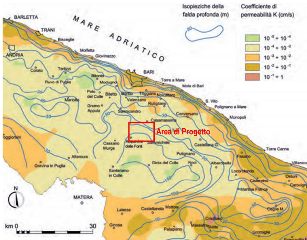
Figura 2.16: Isopieziche della falda profonda e distribuzione del coefficiente di permeabilità dell'acquifero carbonatico appartenente all'area idrogeologica della Murgia
