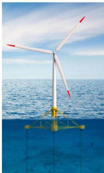
Figura 2.4 – Piattaforma di tipo tension leg platform.
