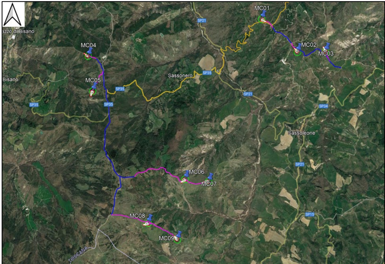
Figura 2.6: Layout d'impianto con sistema di viabilità esistente (linee blu) e di progetto (linee magenta) su immagine satellitare
