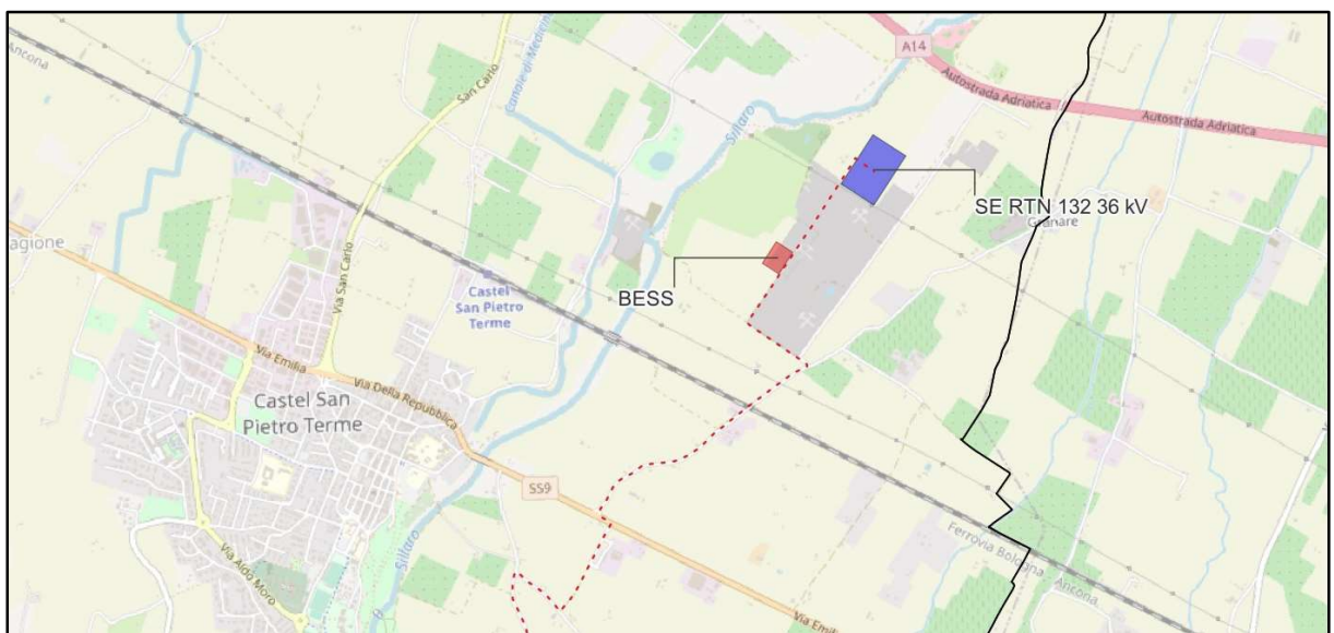
Figura 2.5: Inquadramento SE RTN di nuova realizzazione in Entra-Esci su linea RTN a 132 kV “Castel S. Pietro – Imola CP”.
