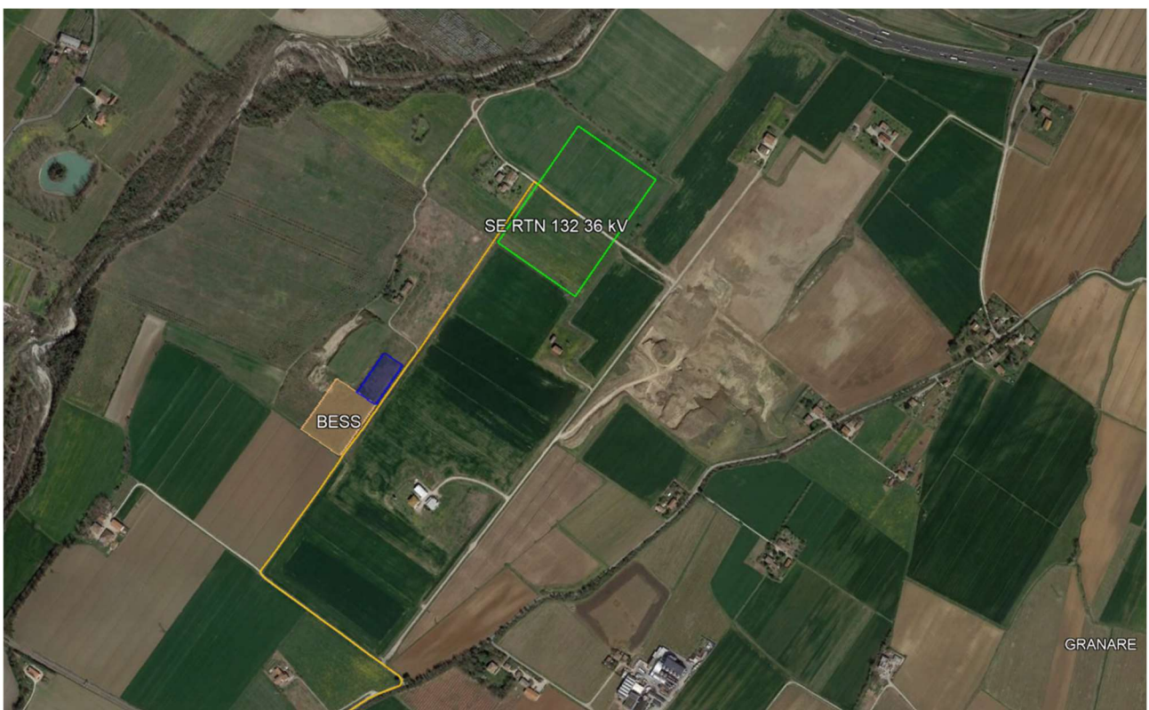
Figura 2.3.3.1: Localizzazione SE 132/36 kV e BESS su ortofoto
