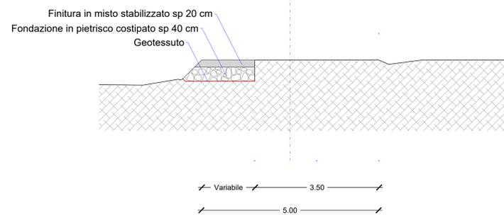
SEZIONE TIPO-ADEGUAMENTO VIABILITA' ESISTENTE\_SCALA 1:50
