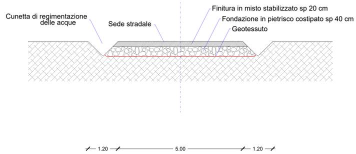
SEZIONE TIPO-SEZIONE IN RILEVATO\_SCALA 1:50
