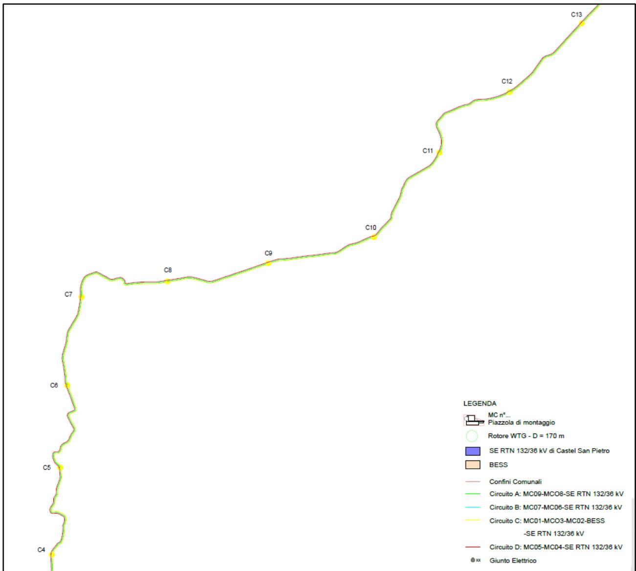
**Figura 6.1.3:** Planimetria di distribuzione linee a 36 kV di collegamento dei circuiti con la SE RTN 132/36 kV di Castel San Pietro Terme
