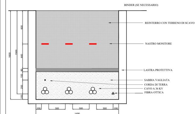
SEZIONE TIPICA CAVIDOTTO A 36 KV SU STRADA ASFALTATA 3 TERNE
