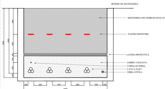
SEZIONE TIPICA CAVIDOTTO A 36 KV SU STRADA ASFALTATA 4 TERNE
