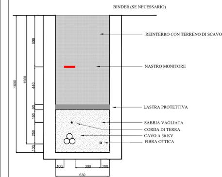
SEZIONE TIPICA CAVIDOTTO A 36 KV SU STRADA ASFALTATA 1 TERNA
