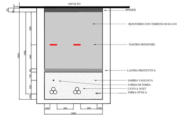
SEZIONE TIPICA CAVIDOTTO A 36 KV SU STRADA STERRATA 3 TERNE
