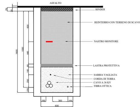
SEZIONE TIPICA CAVIDOTTO A 36 KV SU STRADA STERRATA 2 TERNE
