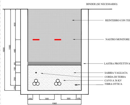
SEZIONE TIPICA CAVIDOTTO A 36 KV SU STRADA ASFALTATA 2 TERNE
