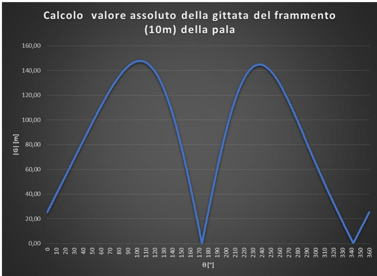
Figura 8.3: Grafico del valore assoluto della gittata del frammento di lunghezza 10 m della pala
