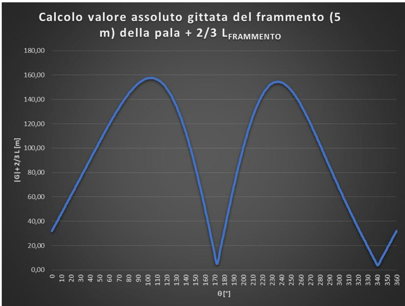
**Figura 8.2:** Grafico del valore assoluto della gittata del frammento di lunghezza 5m della pala +  $2/3 L_{FRAMMENTO}$
