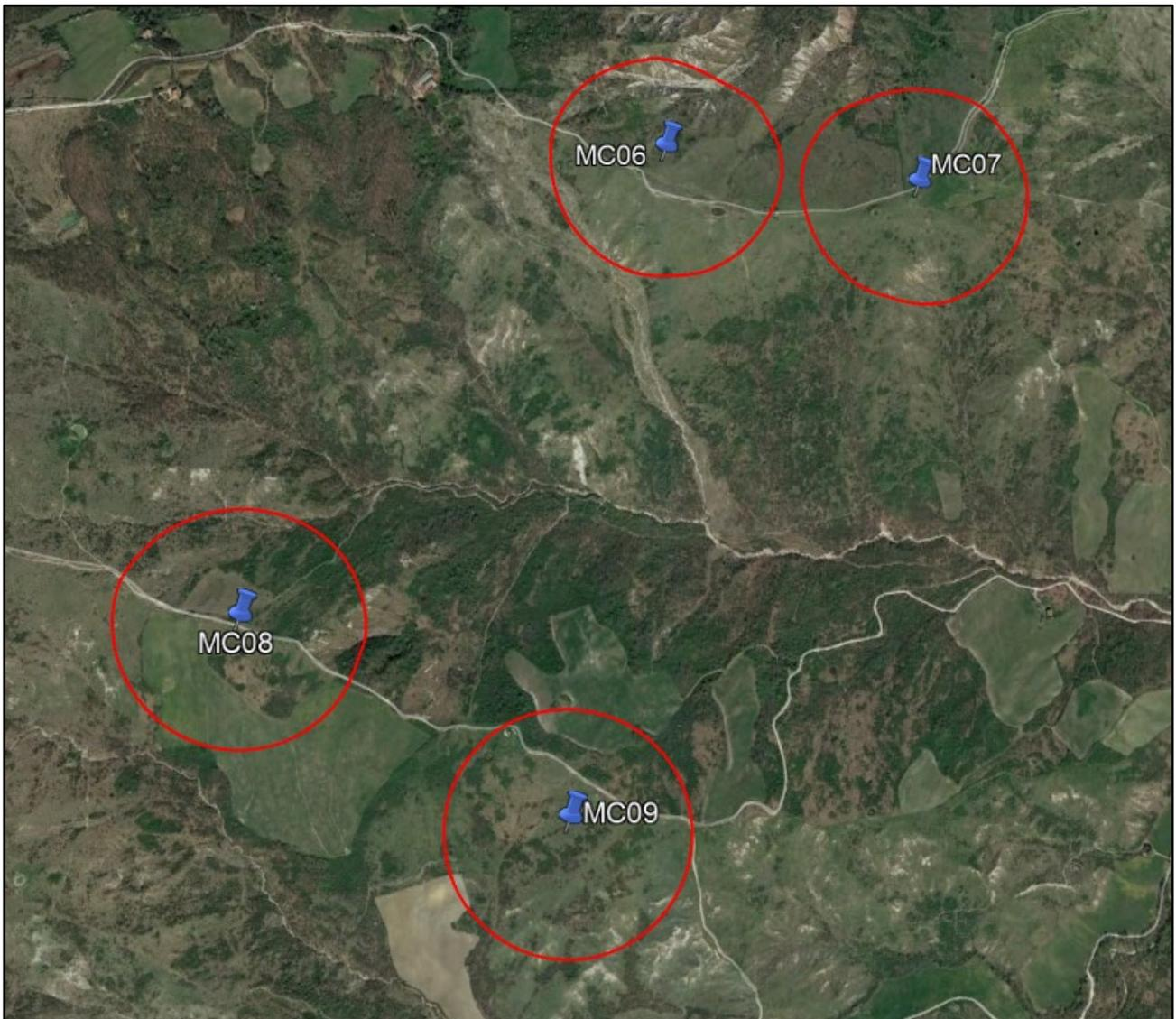
**Figura 9.3:** Aree interessate dalla rottura della pala relativamente agli aerogeneratori MC06, MC07, MC08 e MC09
