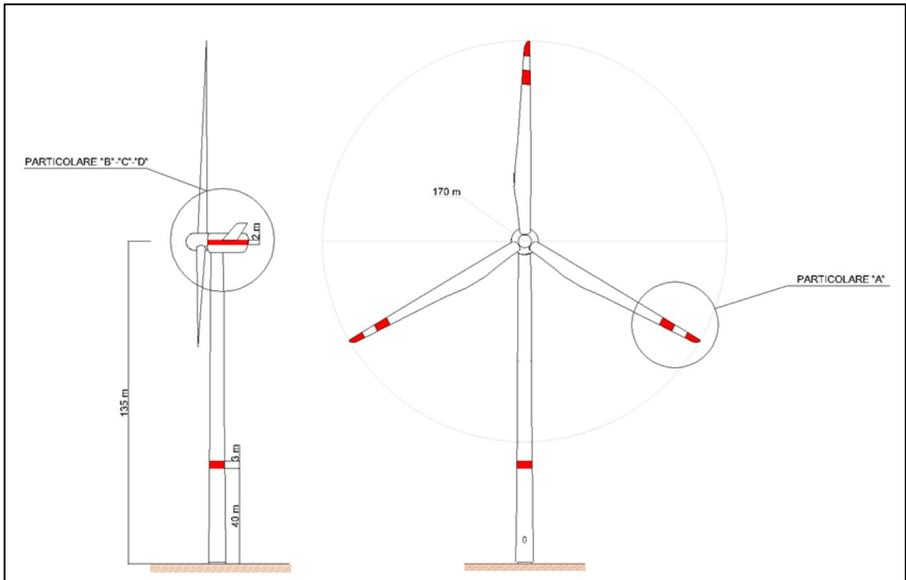
Figura 2.1: Profilo aerogeneratore SG170 – 6.0 MW
