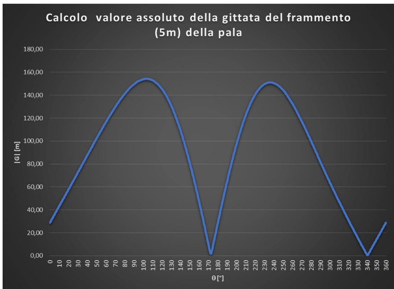
Figura 8.1: Grafico del valore assoluto della gittata del frammento di lunghezza 5m della pala
