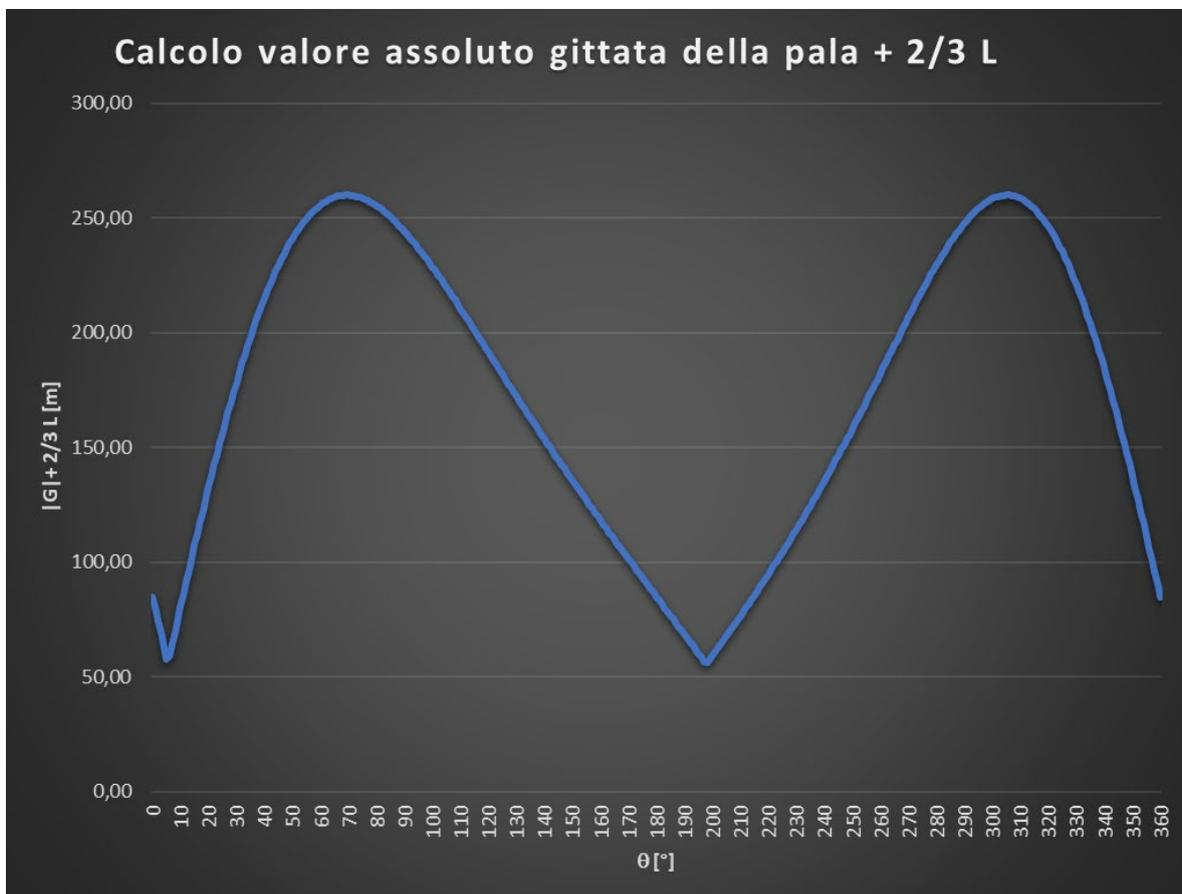
Figura 7.4: Rappresentazione grafica del valore assoluto della gittata della pala +  $\frac{2}{3}L$
