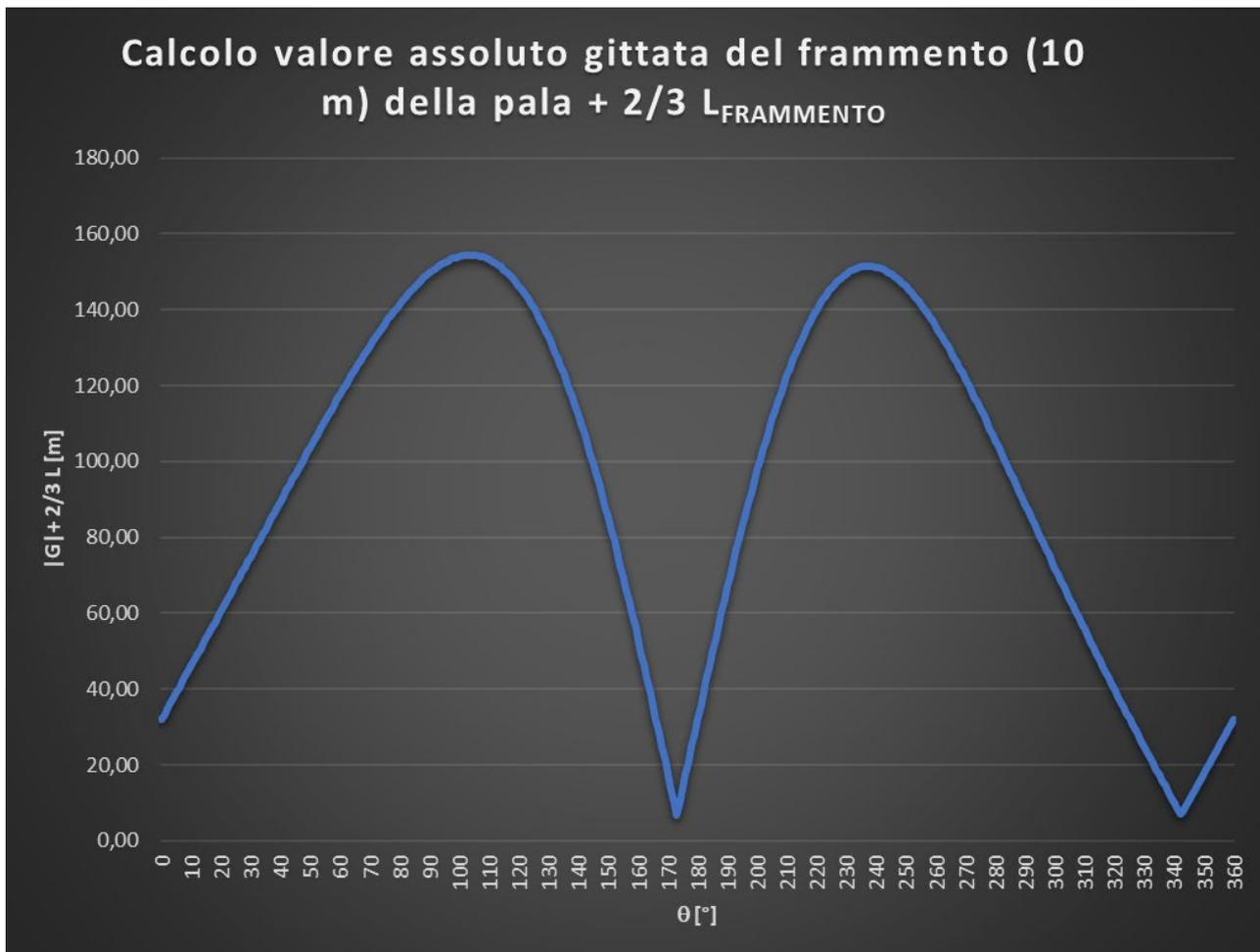
**Figura 8.4:** Grafico del valore assoluto della gittata del frammento di lunghezza 10 m della pala +  $2/3 L_{FRAMMENTO}$
