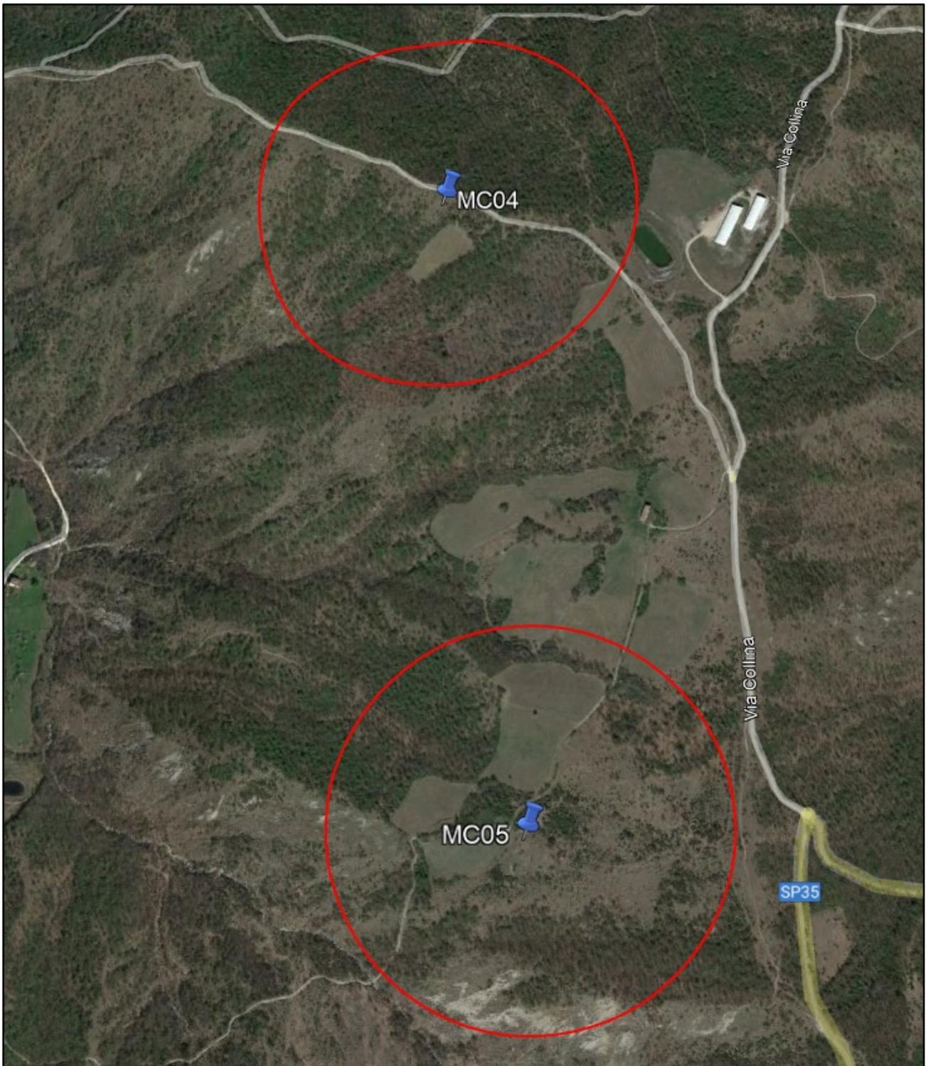
**Figura 9.2:** Aree interessate dalla rottura della pala relativamente agli aerogeneratori MC04 e MC05
