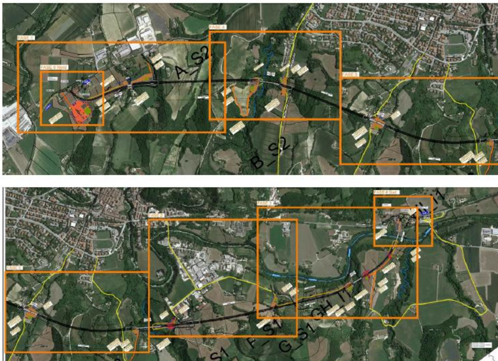
Figura 12 Planimetria generale su ortofoto con individuazione del Campo Base, dei Campi Operativi e delle viabilità di accesso.
