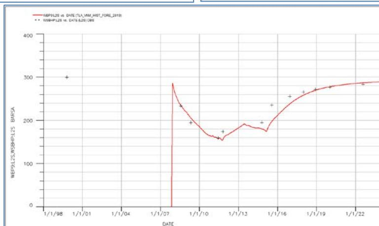
Figura 7 – Campo di TLA: confronto tra dati di pressione da profili statici e modello Eclipse dic.2019
