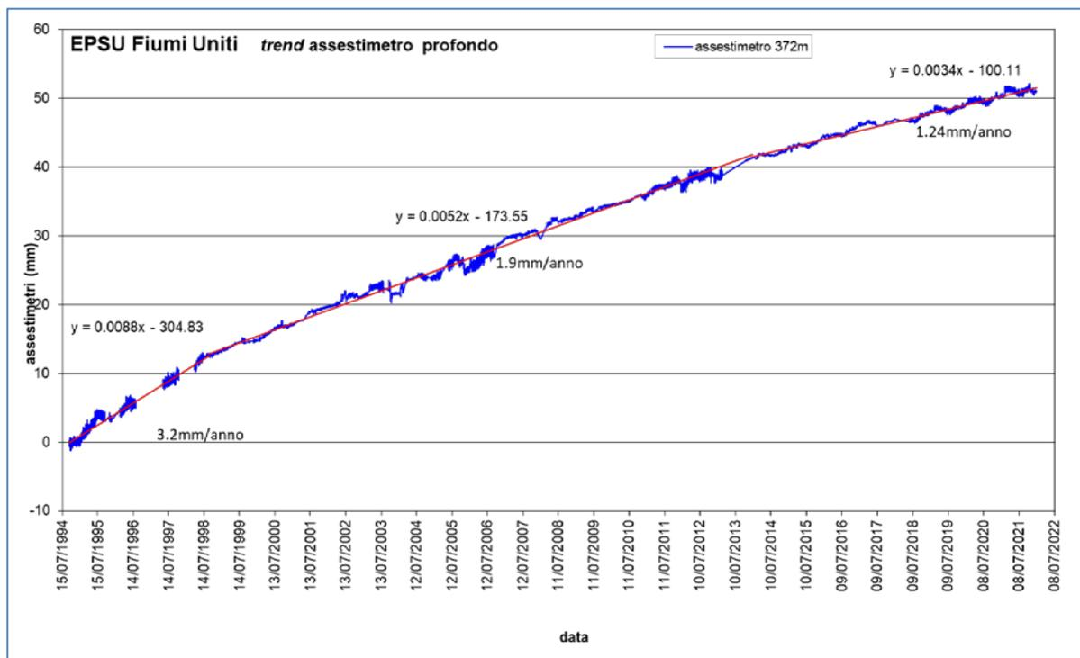
**Figura 14B - Trend curva di compattazione dell'assestimetro della stazione EPSU di F. Uniti**
