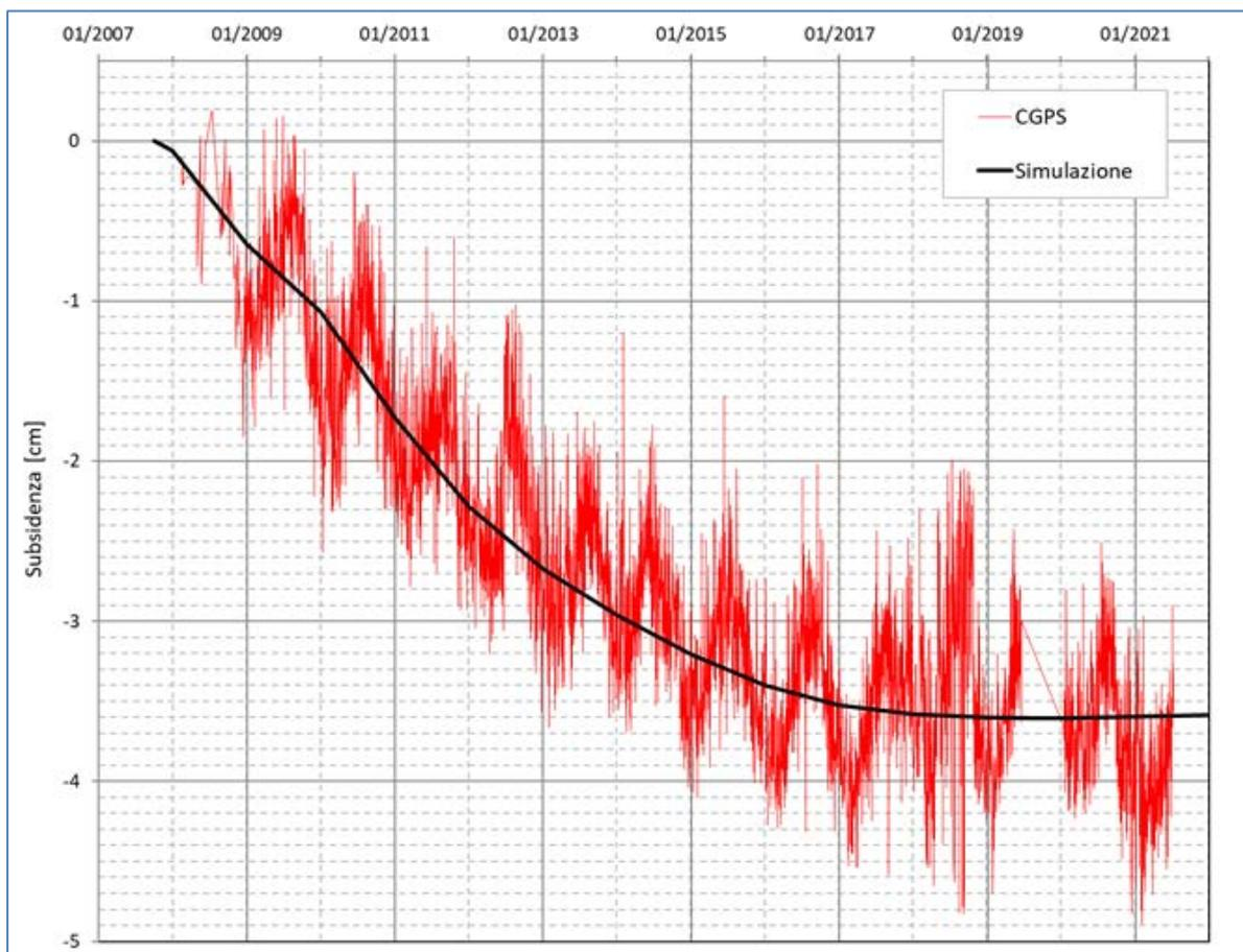
**Figura 6 - Campo di TLA: confronto tra spostamento simulato da modello (linea rossa) e spostamento misurato (linea nera), in corrispondenza della stazione CGPS di Tea**
