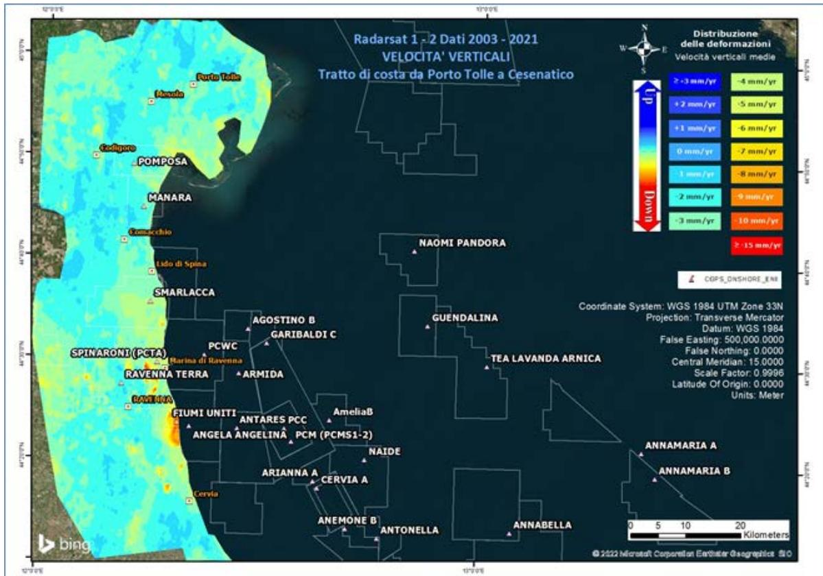
Figura 9 - Campo di TLA: analisi dati SAR dal 2003 al 2021
