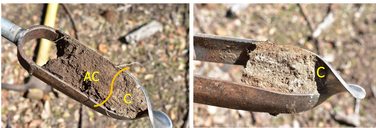
Figura 27 – A sinistra dettaglio del cambio di orizzonte rilevato tramite trivella. A destra dettaglio dell'orizzonte C
