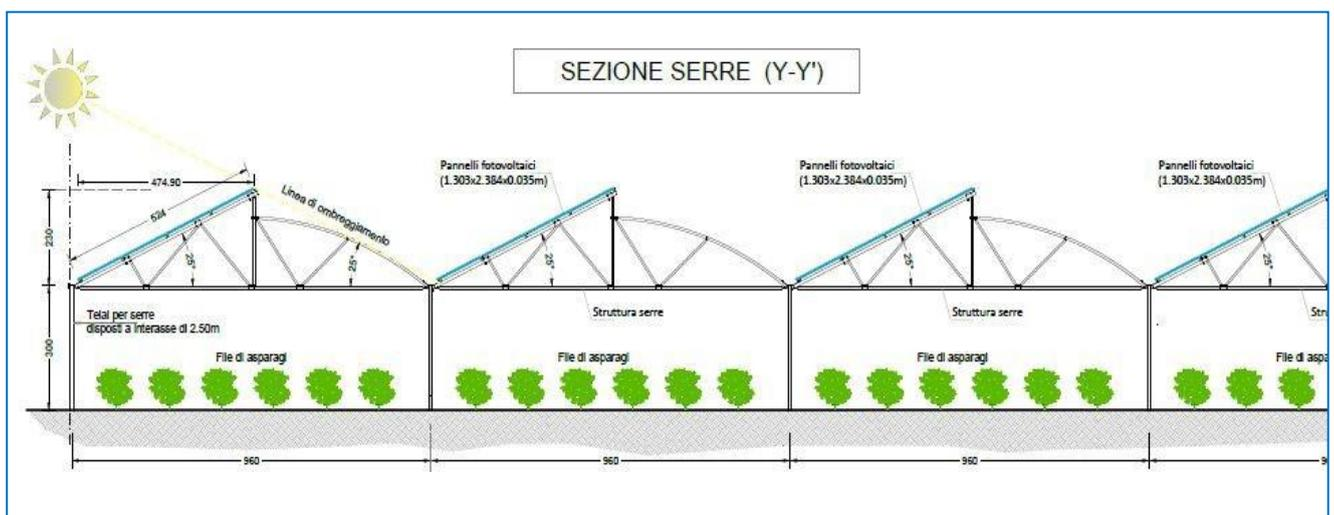
Figura 10 - Stralcio sezione delle serre agrivoltaiche
