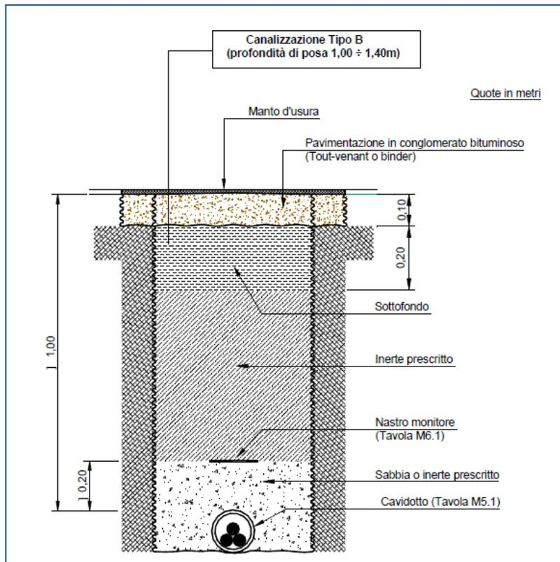
Figura 3 - Posa Tipo "B" cavo MT
