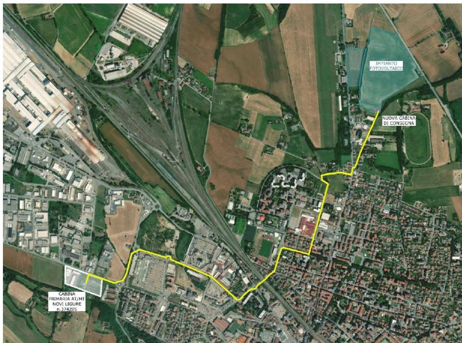
Realizzazione di due linee elettriche MT 15 kV in cavo interrato sezione 240 mm<sup>2</sup> (Al) per una lunghezza di circa 3100 m, suddivise nei seguenti tratti:
