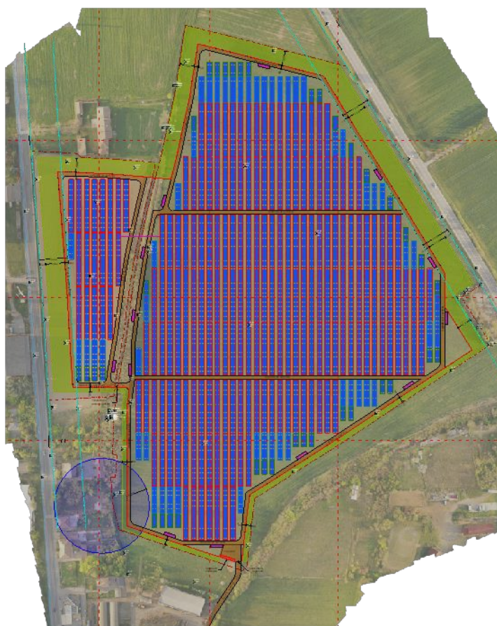
Distribuzione dei tracker fotovoltaici sulla superficie prativa
