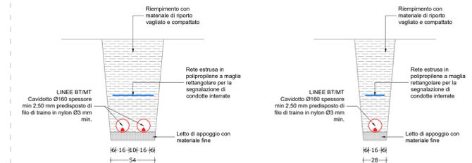
SEZIONE TIPO POSA CAVIDOTTI SU VIABILITÀ IN PROGETTO
