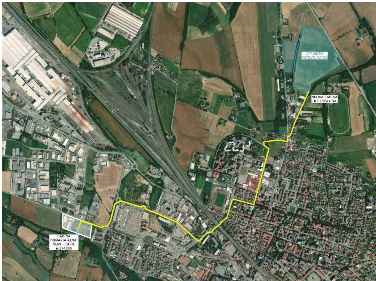
Figura 3. Ortofoto impianto di rete
