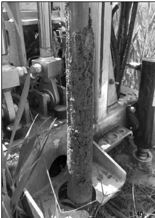
Foto n.2: Prova penetrometrica dinamica DPSH - P2
