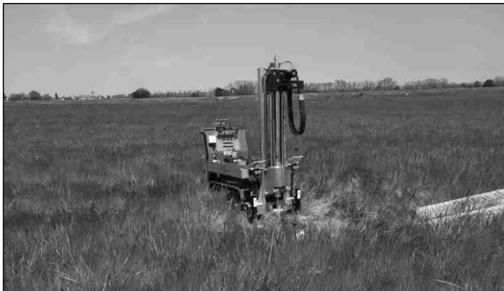
Foto n.5: Prova penetrometrica DPSH - P3
