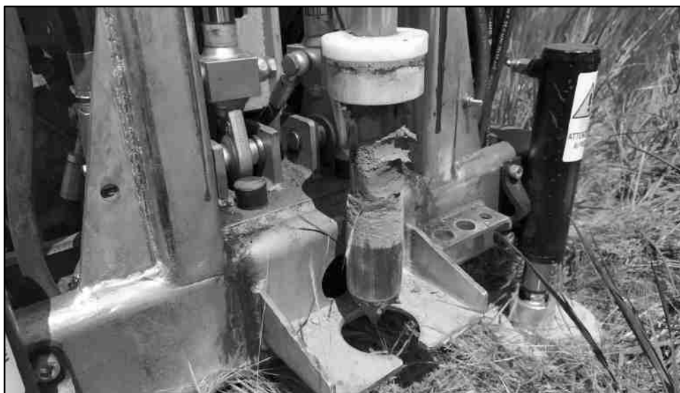
Foto n.6: Foto n.3: Prova penetrometrica dinamica DPSH – P3. Estrazione ultima asta: presenza di limi argillosi di colore marrone chiaro, molto plastici, ma non saturi
