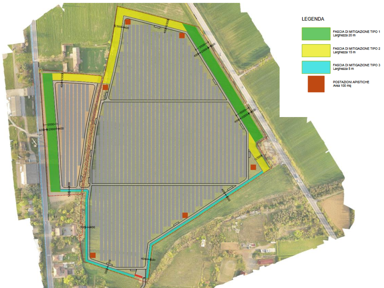
Figura 24 - Inserimento delle postazioni apistiche nel contesto del parco fotovoltaico e delle relative mitigazioni a verde
