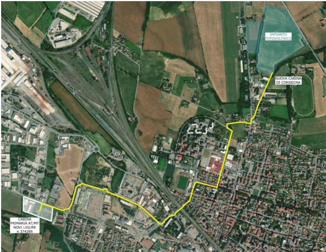
Figura 17 - Impianto di rete su ortofoto
