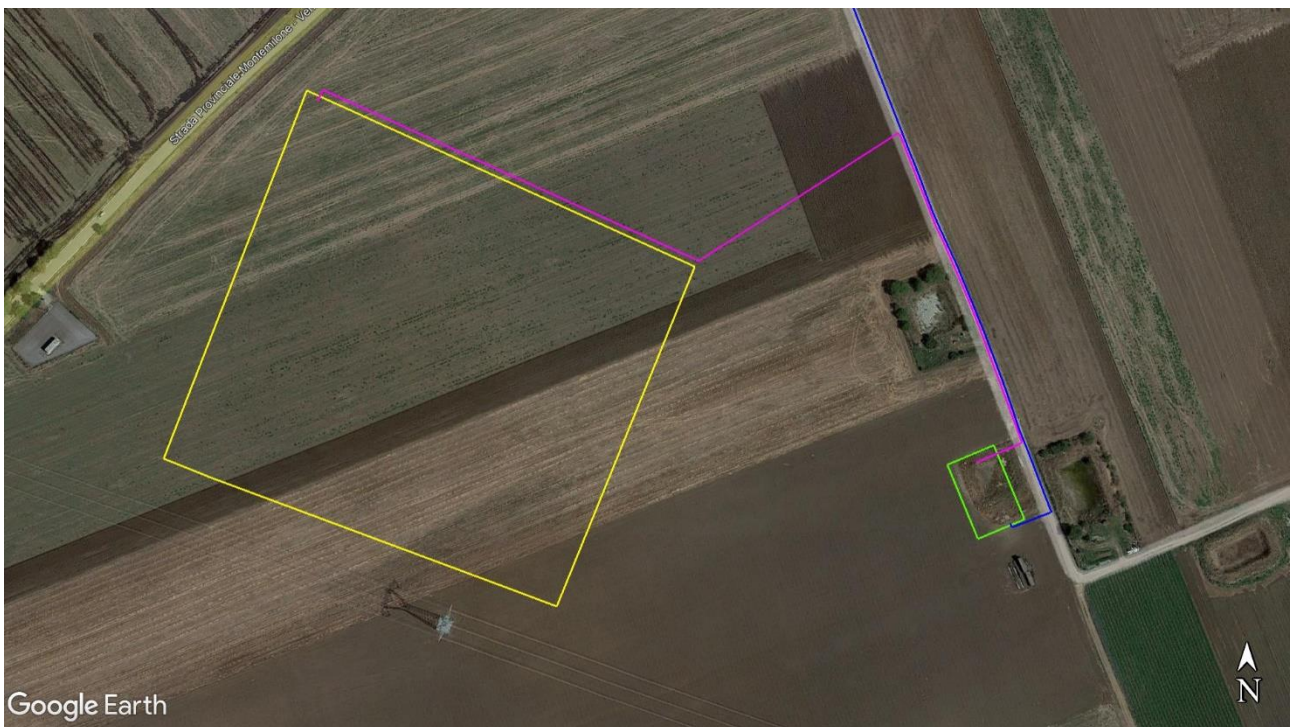
Connessione dell'impianto alla RTN (in blu il cavidotto MT, in verde la SSE, in rosa il cavidotto AT, in giallo la SE Terna)
