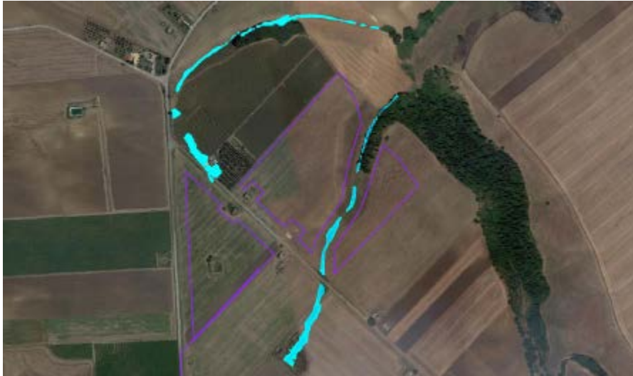
Mappa di esondazione. Dettaglio Aree di progetto A1, A2, B – Tempo ritorno 200 anni
