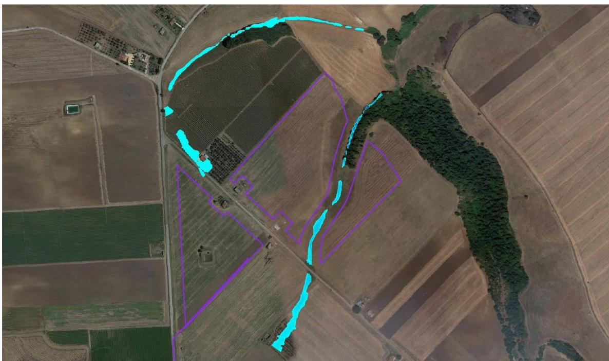
*Fig. 5.2.2a – Dettaglio mappa di esondazione su Ortofoto area di impianto settentrionale*
