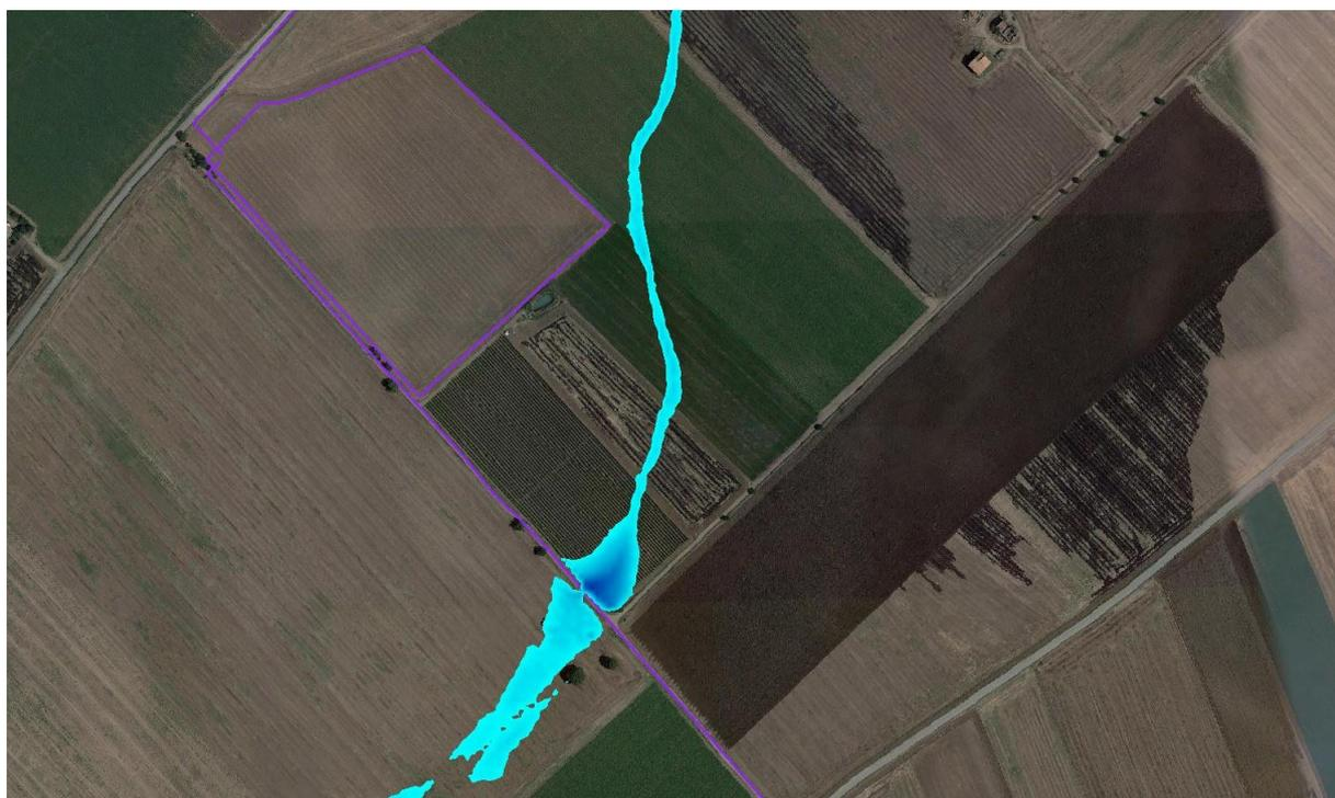
*Fig. 5.2.2b – Dettaglio mappa di esondazione su Ortofoto area di impianto meridionale e cavidotto*
