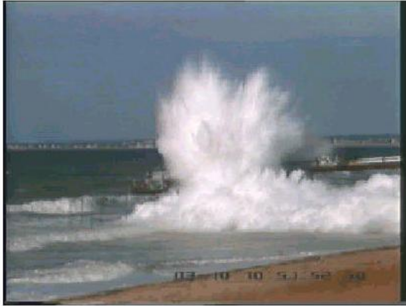
Figura 3 (tratta da [5]) – Fenomeno di RPT da rilascio di 9 m 3 di GNL in acqua (Lorient, Francia, Ottobre 1984)
