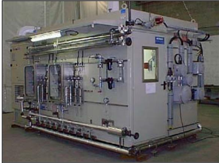
Figura 34 - Skid Sistema di analisi – Cabina cromatografi
