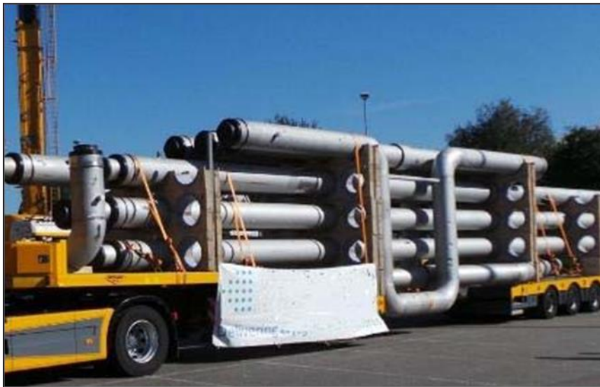
Figura 22 - Loops di espansione per le tubazioni VIP
