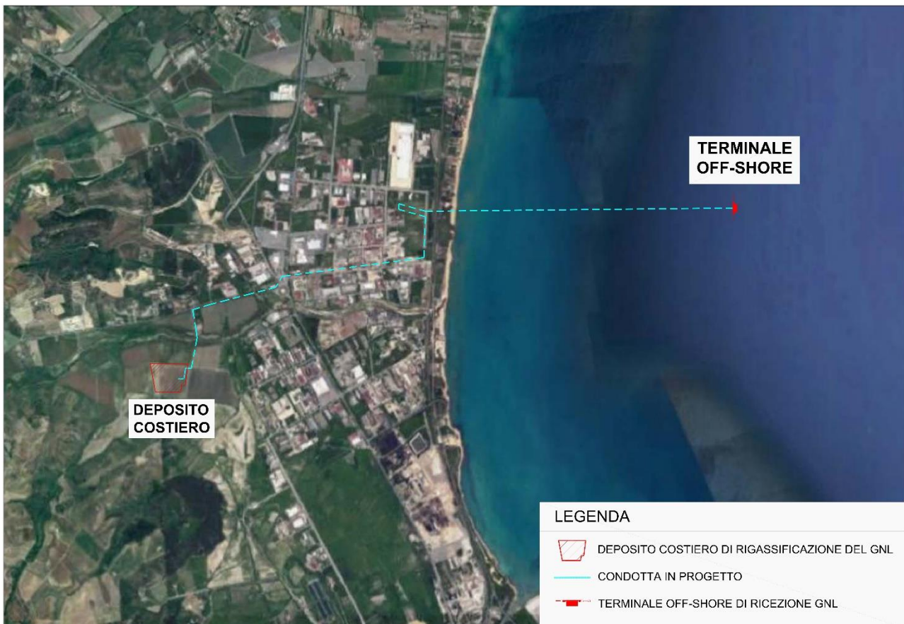
Figura 20 - Immagine satellitare da Google Earth con evidenziato il tracciato planimetrico della condotta in progetto concordato con SNAM
