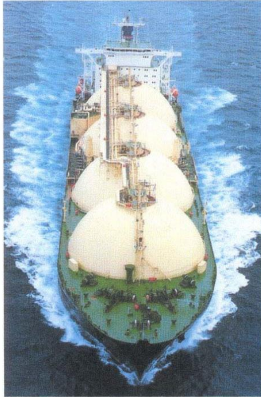
Figura 2 - Esempio di nave metaniera con serbatoi sferici (tecnologia Moss-Rosenberg)
