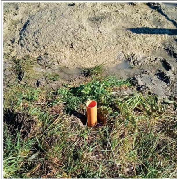
Foto 11 – Piezometro installato nel sondaggio S.2-Pz
