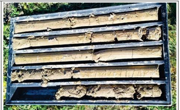
Foto 8 - Sondaggio S.2-Pz da 5.00 a 10.00 metri
