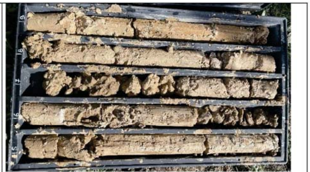
Foto 5 - Sondaggio S1 da 15.00 a 20.00 metri
