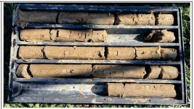
Foto 3 - Sondaggio S1 da 5.00 a 10.00 metri
