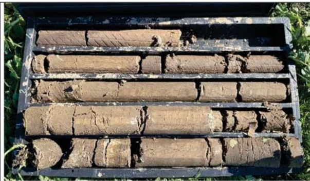
Foto 2 - Sondaggio S1 da 0.00 a 5.00 metri
