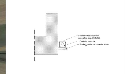
**Elettrodotto AT sul ponte esistente di attraversamento del corso d'acqua**
