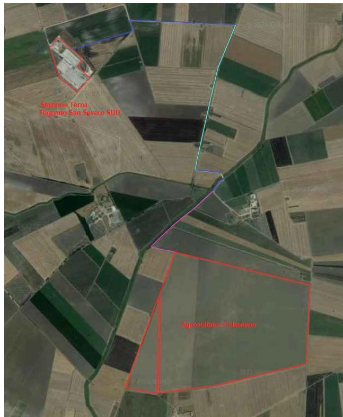
Figura 5-3 - Tracciato cavidotto AT su foto aerea
