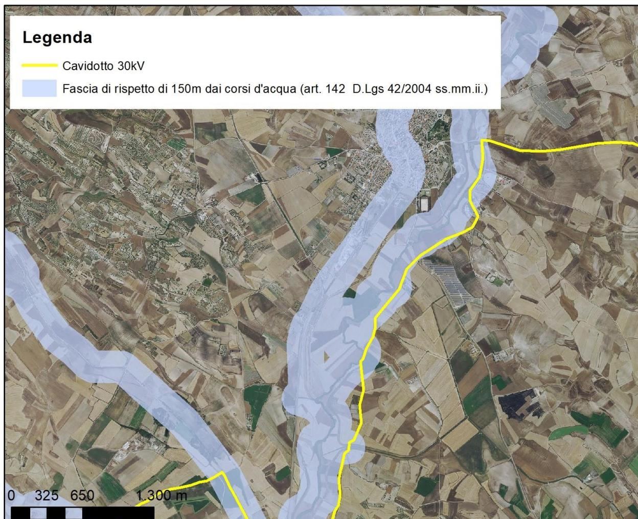
*Figura 2.3 - Sovrapposizione del cavidotto 30kV ivi impostato su viabilità esistente con la fascia di tutela paesaggistica di 150m del "Flumini Mannu\_041"*
