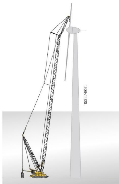
Figura 5.21 – Schema di una gru cingolata a traliccio con sistema derrick impiegata per l'innalzamento delle turbine eoliche dell'ultima generazione
